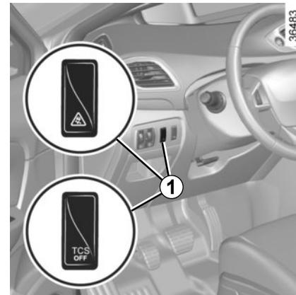
Poiché il sistema di controllo della trazione rappresenta un ulteriore elemento di sicurezza, si raccomanda di non viaggiare con la funzione inibita. Se non potete farne a meno limitate al massimo il tempo di disattivazione premendo appena possibile il contattore **1**.
