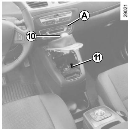
**All'avviamento**, se la leva è bloccata su **P**, quando premete il pedale del freno e il pulsante di sbloccaggio **10**, è possibile liberarla manualmente. Per fare ciò, sganciate il supporto della leva del cambio cominciando dal lato situato sotto i comandi **A** di climatizzazione, premete il pulsante **11** e premete contemporaneamente il pulsante di sbloccaggio **10** disposto sulla leva.
