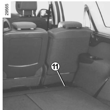
Según el vehículo, debe retirar las anillas de amarre **11** antes de instalar una red de separación de los equipajes.
