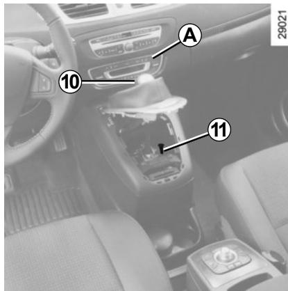
**Durante la puesta en marcha**, si la palanca se queda bloqueada en **P**, es posible liberar manualmente la palanca si se pisa a la vez el pedal de freno y el botón de desbloqueo **10**. Para ello, suelte la base de la palanca de velocidades comenzando por el lado situado bajo los mandos **A** de climatización, presione el botón **11** y presione simultáneamente el botón de desbloqueo **10** situado en la palanca.
