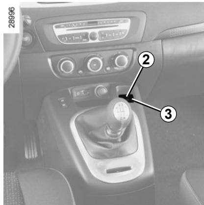
La activación del freno de aparcamiento asistido se confirma con el mensaje «Freno aparcamiento activado» y el testigo
