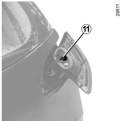
Ziehen Sie die Leuchteneinheit von außen heraus und lösen Sie den Lampenträger **11** um eine Vierteldrehung.
