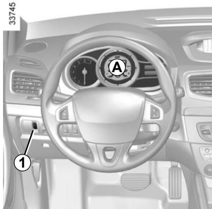
Quando liga a ignição, o quadro de instrumentos acende. Rode o botão **1** para regular a intensidade luminosa do quadro de instrumentos. Nalguns casos, os indicadores acendem com a mensagem.
