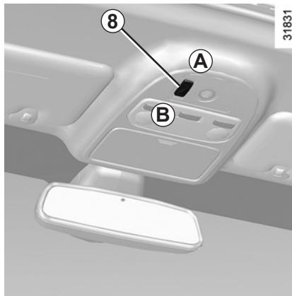
Fermeture entrebâillement : appuyez brièvement sur le bouton 8 (le côté A).
