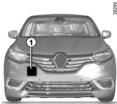
Tramite il radar **1**, questa funzione avvisa il conducente dell'intervallo di tempo che lo separa dal veicolo che lo precede, in modo da rispettare le distanze di sicurezza tra i 2 veicoli.
