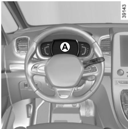
**Quadro della strumentazione A:** Si accende quando si apre la porta del conducente.
