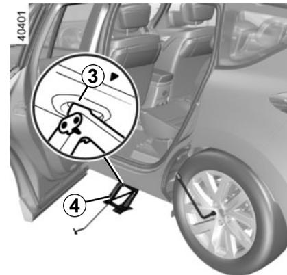
Coloque el gato **4** en posición horizontal. Es **fundamental** colocar la cabeza del gato en el soporte de chapa **3**.
