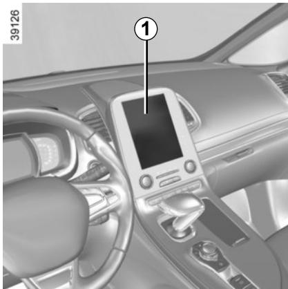
Esta función, integrada en la pantalla multifunción **1**, permite, según el equipamiento del vehículo, la activación/desactivación y el ajuste de algunas funciones del vehículo.
