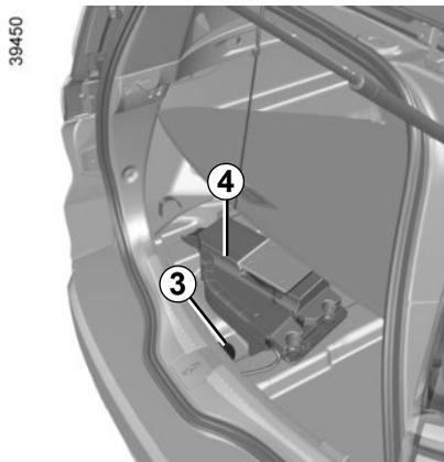
Vuelva a colocar el obturador y después la tapa **3**.
