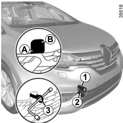
Utilice exclusivamente los puntos de remolcado delanteros **1** y traseros **4** (nunca los tubos de transmisión o cualquier otra parte del vehículo). Estos puntos de remolcado tan solo se pueden emplear para remolcar, en ningún caso deben servir para levantar directa o indirectamente el vehículo.
