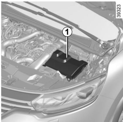
La batería **1** no necesita mantenimiento. **No debe abrirla o añadir ningún líquido.**
