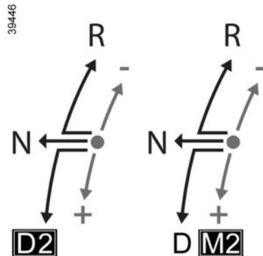
La relación de la velocidad medida aparece en primer lugar a la derecha de **D** en el cuadro de instrumentos y, a continuación, aparece **M** seguido de la marcha medida debajo de **+** cuando se active el modo manual permanente.
