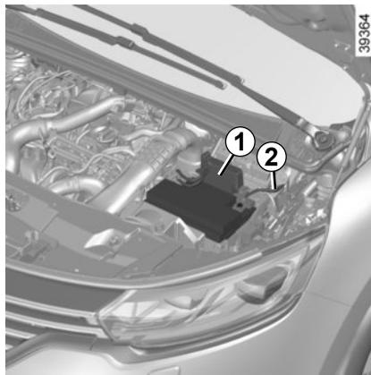
Levante a tampa vermelha da caixa **1** situada por trás da bateria.
