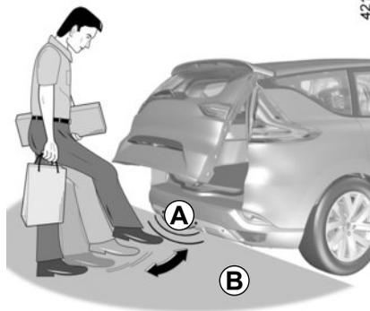
Der Sensor erkennt die Annäherung und Entfernung Ihres Fußes und löst das Öffnen oder Schließen der Heckklappe aus.
