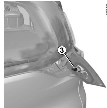
Ziehen Sie die Leuchteneinheit von außen heraus und lösen Sie den Lampenträger **3** um eine Vierteldrehung.
