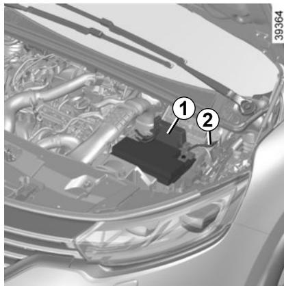
Heben Sie die rote Abdeckung des Moduls **1** hinter der Batterie an.
