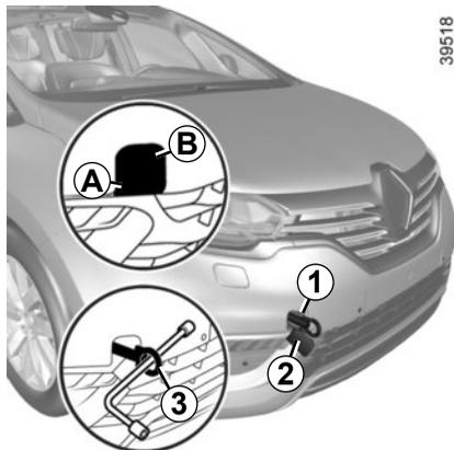
Verwenden Sie zum Abschleppen ausschließlich die Abschleppösen vorne 1 und hinten 4 (keinesfalls aber die Antriebswellen oder andere Teile des Fahrzeugs). Die Abschleppösen sind nur für Belastung durch Zug ausgelegt und dürfen nicht verwendet werden, um das Fahrzeug direkt oder indirekt anzuheben.
