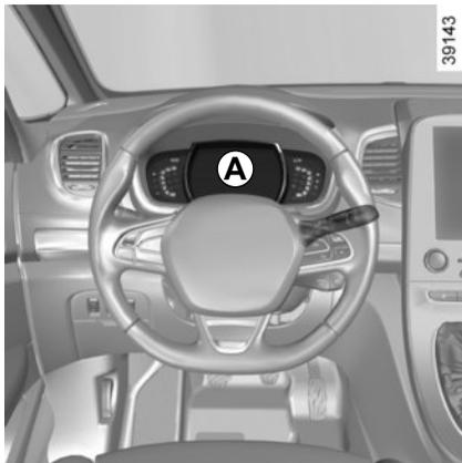
**Instrumententafel A:** Sie leuchtet beim Öffnen der Fahrertür auf.
