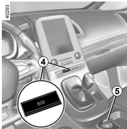
Während der Fahrt ist es möglich, den ECO-Modus zeitweise zu verlassen, um optimale Motorleistungen nutzen zu können.
