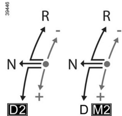
Der eingelegte Gang erscheint zunächst rechts von **D** an der Instrumententafel, dann erscheinen **M** und der eingelegte Gang unter **+**, nachdem der dauerhafte manuelle Modus aktiviert wurde.
