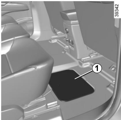
Verwenden Sie im Falle einer Reifenpanne den Reparatursatz in der Klappe **1** im Fußraum des rechten hinteren Sitzplatzes der zweiten Sitzreihe.
