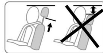
Ist eine Kopfstütze vollständig nach unten gedrückt, befindet sie sich in **Ablageposition**: Diese Position darf nicht verwendet werden, wenn auf dem jeweiligen Sitz eine Person sitzt.
