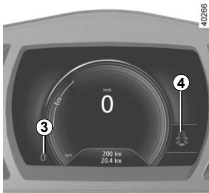
Ab einer Fahrgeschwindigkeit von ca. 20 km/h zeigt eine Kontrolllampe an, wenn eine Tür oder der Gepäckraum offen oder nicht richtig geschlossen ist, zusammen mit der Meldung „Heckklappe offen“ oder „Tür offen“, und ein akustisches Signal ertönt ca. 40 Sekunden lang oder bis zum Schließen der Tür/des Gepäckraums.
