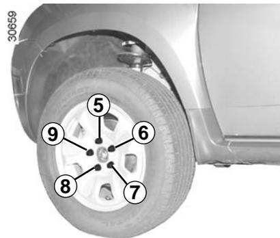
Aperte os parafusos, assegurando-se de que a roda esteja bem encostada ao cubo e baixe o macaco.
