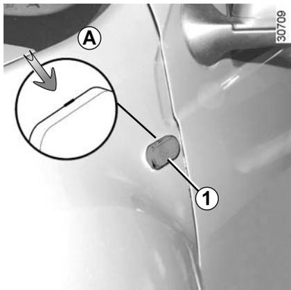
Desencaixe o pisca-pisca **1** (com uma ferramenta aplicada em **A**, desloque o pisca-pisca na direção exterior do veículo).
