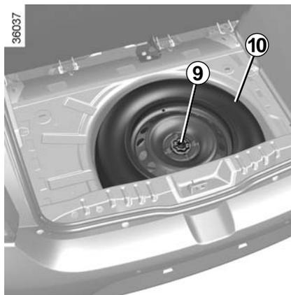
**Observação:** assegure-se de que o estepe, ou a roda com furo, e o alojamento da roda estejam bem dispostos, para permitir a correta fixação do tapete do porta-malas.
