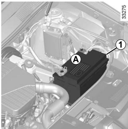
A bateria **1** não necessita de manutenção.
