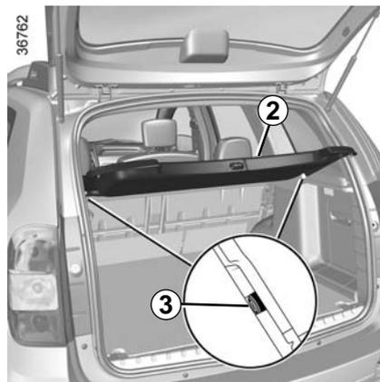
Levante o tampão **2** a uma altura intermédia para desencaiçar as fixações **3** situadas em cada lado do tampão.
