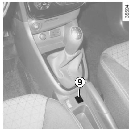
**Vehículos equipados con el modo ECO (contactor 9):** si está accionado, el modo ECO puede disminuir el rendimiento del aire acondicionado automático. Consulte el apartado «Consejos de conducción, ecoconducción» en el capítulo 2.
