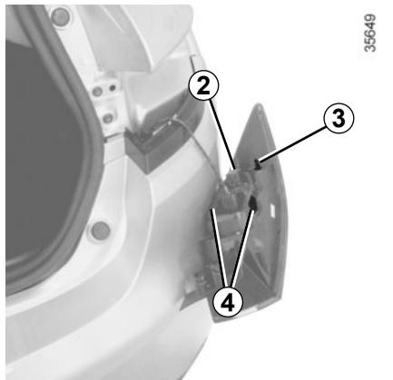
Para soltar el bloque de luces, en primer lugar, separe suficientemente el lado exterior (movimiento **A**) para soltar el clip **3** y tire del bloque de luces hacia atrás (movimiento **B**).
