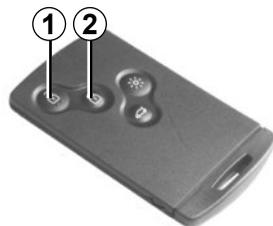
Cuando el vehículo va equipado con la supercondenación, ésta permite bloquear los abrientes e impedir así la apertura de las puertas por las empuñaduras interiores (caso, por ejemplo, de una rotura del cristal seguida de un intento de abrir las puertas por el interior).
