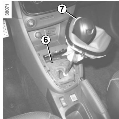
**Al poner el vehículo en marcha**, si la palanca se queda bloqueada en **P** al pisar el pedal de freno, existe la posibilidad de liberarla manualmente. Para ello, suelte la base de la palanca, pase una herramienta (varilla rígida) por la ranura **6** y pulse simultáneamente el botón **7** para desbloquear la palanca.
