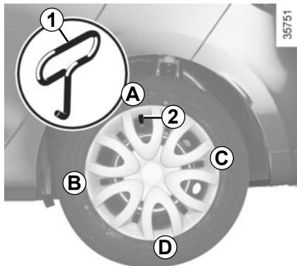
Extráigalo mediante la llave del emblecedor **1** (situada en el bloque de herramientas) introduciendo el gancho en el orificio previsto cerca de la válvula **2**.
