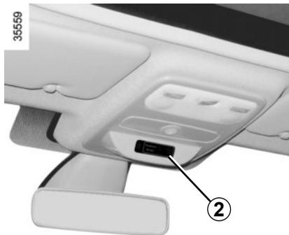
**Para reactivar los airbags: con el vehículo parado, el contacto cortado, empuje y gire el cerrojo 1 hasta la posición ON.**
