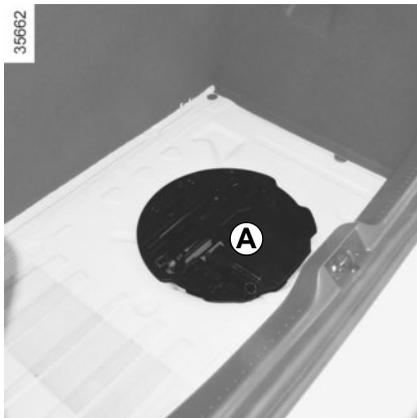
A presença das ferramentas no bloco de ferramentas depende do veículo. O bloco de ferramentas **A** está situado no compartimento, sob o tapete de porta-bagagens. Levante a tampa e retire-a.
