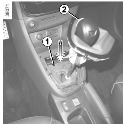
Dans le cas où le levier est bloqué sur **P** alors que vous appuyez sur la pédale de frein, il y a possibilité de libérer manuellement le levier. Pour cela, déclipsez la base du levier, puis passez un outil (tige rigide) dans la fente **1** et appuyez simultanément sur le bouton **2** afin de déverrouiller le levier.
