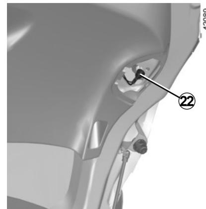
Tournez le porte-lampe **22** dans le sens inverse des aiguilles d'une montre et changez la lampe.
