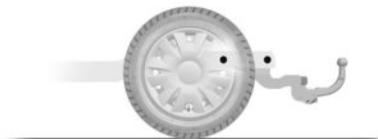
Si la boule d'attelage masque la plaque d'immatriculation ou le feu de brouillard arrière du véhicule, vous devez la retirer lorsque vous ne tractez pas.
