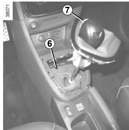
**À la mise en route**, dans le cas où le levier est bloqué sur **P** alors que vous appuyez sur la pédale de frein, il y a possibilité de libérer manuellement le levier. Pour cela, déclipsez la base du levier, puis passez un outil (tige rigide) dans la fente **6** et appuyez simultanément sur le bouton **7** afin de déverrouiller le levier.
