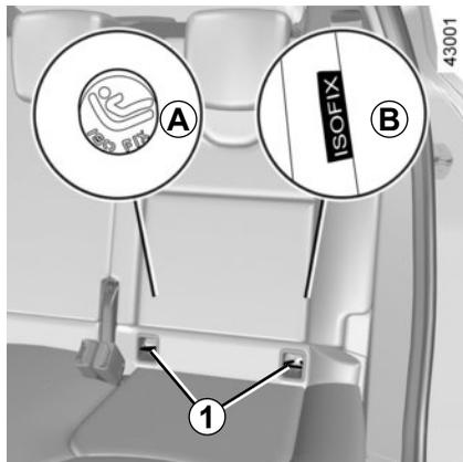
Les deux anneaux **1** sont situés entre le dossier et l'assise du siège et sont repérés, suivant véhicule, par un marquage **A** ou **B**.
