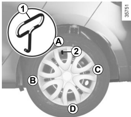
Déposez-le à l'aide de la clé d'enjoliveur **1** (située dans le bloc-outils) en engageant le crochet dans l'ouverture prévue à proximité de la valve **2**.
