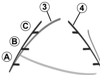
Ce gabarit reste fixe et indique la trajectoire du véhicule si les roues sont en ligne avec le véhicule.
