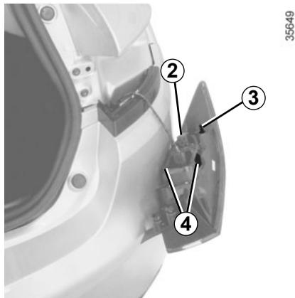
Pour dégager le bloc feux, commencez par écarter suffisamment le côté extérieur (mouvement **A**) pour dégager le clip **3** puis tirez le bloc feux vers l'arrière (mouvement **B**).
