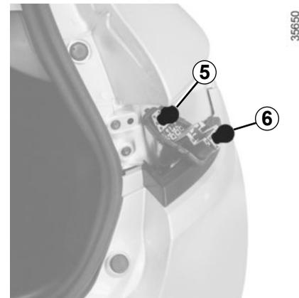
Remontez le porte-lampe et poussez le bloc à fond jusqu'au verrouillage.
