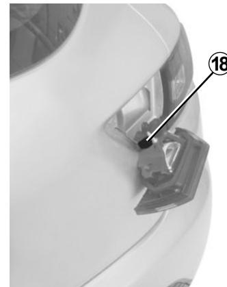
Tournez le porte-lampe **18** dans le sens inverse des aiguilles d'une montre et changez la lampe.
