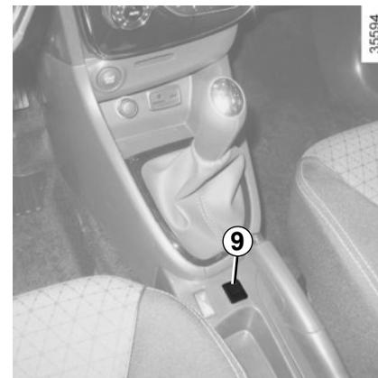
**Véhicules équipés du mode ECO (contacteur 9)** : lorsqu'il est actionné, le mode ECO peut diminuer les performances de l'air conditionné automatique. Reportez-vous au paragraphe « Conseils de conduite, ECO conduite » en chapitre 2.
