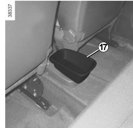
**Abnehmbare Ablage der Mittelkonsole hinten 17**
