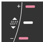
Indicatore cambio di marcia per cambio manuale. È acceso un solo cursore per volta - durante la guida normale è acceso solamente quello centrale.
