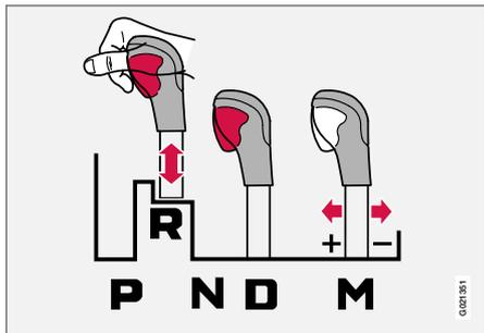
La leva può essere portata liberamente in avanti o all'indietro tra **N** e **D**. Le altre posizioni hanno un blocco che viene manovrato tramite il pulsante di bloccaggio sulla leva selettore.
