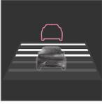
È possibile selezionare diverse distanze temporali dal veicolo antistante, che vengono visualizzate sul quadro strumenti con 1-5 linee orizzontali - più linee sono visualizzate, maggiore è la distanza temporale. 1 linea cor-
