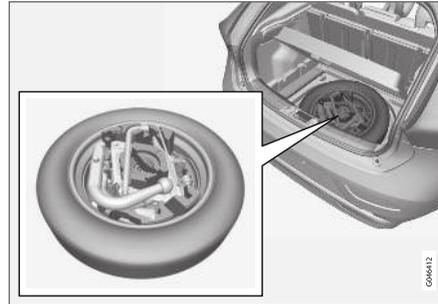
1. Sollevare il bordo posteriore del pavimento del bagagliaio (oppure, nei modelli con pavimento ripiegabile, afferrare la maniglia sul pavimento, sollevare e spostare in avanti la parte posteriore del pavimento).
