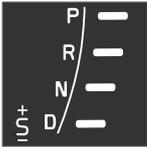
Le posizioni del cambio automatico sono indicate nella parte destra del quadro comandi combinato (è acceso un solo cursore per volta, quello della posizione in cui si trova attualmente la leva selettore).
