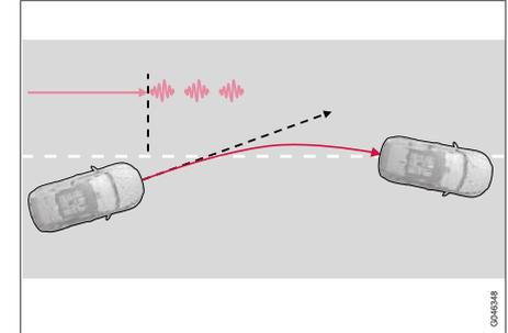
La funzione LKA sterza e avverte il conducente mediante vibrazioni nel volante<sup>35</sup>.
