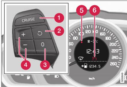
Tastierina al volante e display di un'automobile **senza** limitatore di velocità<sup>4</sup>.
