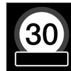
Un simbolo per l'insegna supplementare sotto forma di un riquadro vuoto sotto il segnale di velocità del quadro strumenti<sup>31</sup>, sta ad indicare che RSI ha rilevato un cartello aggiuntivo con informazioni di completamento per il limite di velocità in questione.
