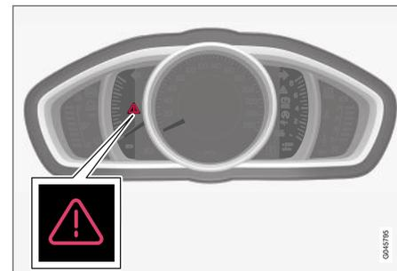
Triangolo di avvertimento nel quadro strumenti analogico.
