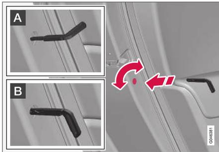
Fermo di sicurezza per bambini manuale. Da non confondere con il Bloccaggio manuale della portiera (p. 175).
