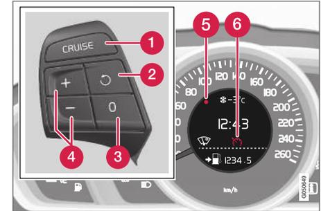
Tastierina al volante e display di un'automobile senza limitatore di velocità<sup>3</sup>.
