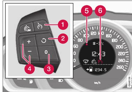
Tastierina al volante e display di un'automobile **con** limitatore di velocità<sup>4</sup>.
