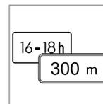
Alcuni limiti di velocità possono essere applicabili ad esempio dopo una determinata tratta oppure in alcune ore del giorno. Questa circostanza è segnalata al conducente tramite un'insegna supplementare sotto il segnale di velocità.
