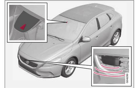
Sensore telecamera e radar<sup>24</sup>.
