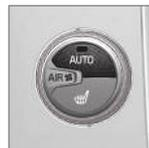
Ruotare la manopola per aumentare o ridurre la velocità della ventola, **AUTO** viene disinserito. Se si seleziona **AUTO**, la velocità della ventola si regola automaticamente (p. 134) - la velocità della ven-
