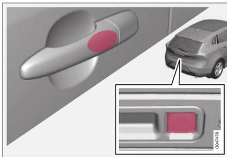
Bloccare le portiere e il portellone agendo su una delle maniglie delle portiere o premere leggermente il pulsante gommato piccolo fra i due del portellone. La spia di bloccaggio (p. 162) sul parabrezza inizia a lampeggiare a conferma del bloccaggio.
