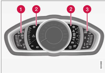
Spie di controllo e allarme, strumentazione analogica.
