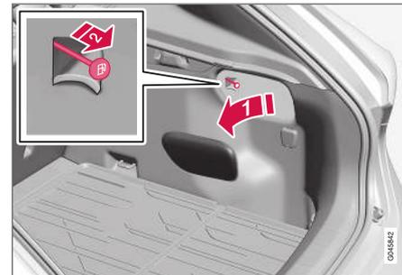
**1** Abra y retire la tapa lateral en el maletero (en el mismo lado que la tapa del depósito).
