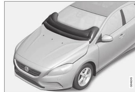
El airbag para peatones (**Pedestrian Airbag**) está instalado debajo del capó junto al parabrisas. En ciertas colisiones frontales con un peatón, los sensores en el parachoques delantero reaccionan y el airbag se despliega si se calcula que la fuerza del impacto es lo suficientemente grande. Los sensores están activos a velocidades de 20-50 km/h (12-30 mph) y a una temperatura ambiente entre -20 y +70 °C.
