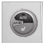
Gire la perilla para aumentar o reducir la velocidad del ventilador, **AUTO** se desconectará. Si se selecciona **AUTO**, la velocidad del ventilador se regulará de forma automática (p. 137). Se desconecta la velocidad de ventilador ajustada con anterioridad.
