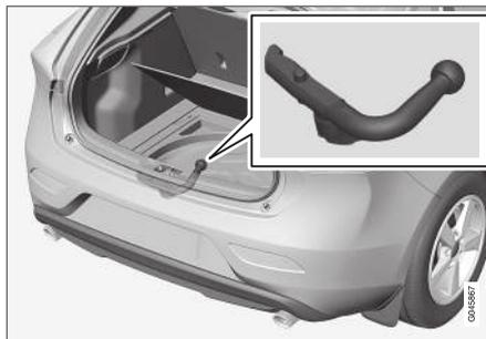
El enganche para remolque desmontable se guarda en el taco de gomaespuma<sup>21</sup> debajo del suelo del maletero cuando no se utiliza.
