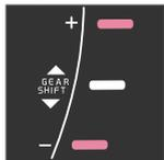
Indicador de cambio de marcha para caja de cambios manual. Sólo se ilumina al mismo tiempo un marcador - en conducción normal se enciende únicamente el situado en medio.
