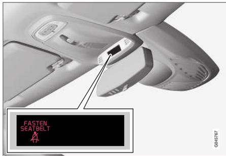
El aviso acústico depende de la velocidad y, en algunos casos, del tiempo. La señal luminosa se puede ver en la consola del techo y en el cuadro de instrumentos (p. 66).
