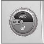
La función Auto regula de forma automática la temperatura (p. 137), el aire acondicionado (p. 138), la velocidad del ventilador (p. 136), la recirculación (p. 139) y la distribución de aire (p. 131).
