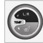
La temperatura del lado del conductor y del lado del acompañante puede ajustarse independientemente. Pulse varias veces **L/R** con el botón para seleccionar el ajuste izquierda, derecha o ambos laterales.
