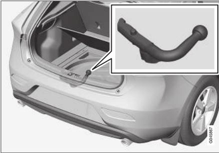
Lorsqu'il n'est pas utilisé, le crochet d'attelage amovible doit être rangé dans le bloc de mousse<sup>18</sup> sous le plancher du compartiment à bagages.
