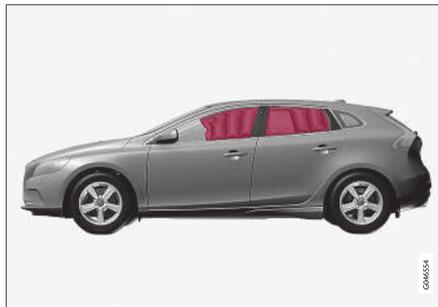
Le rideau gonflable IC (Inflatable Curtain) est un composant du système SIPS (p. 38). Il est dissimulé dans la garniture de plafond des deux côtés de la voiture et il protège le conducteur et les occupants des places extérieures. Lors d'une forte collision, les capteurs réagissent et le rideau gonflable se gonfle.
