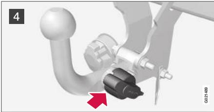
4 Insérez et faites coulisser la boule jusqu'à ce qu'un déclic se fasse entendre.
