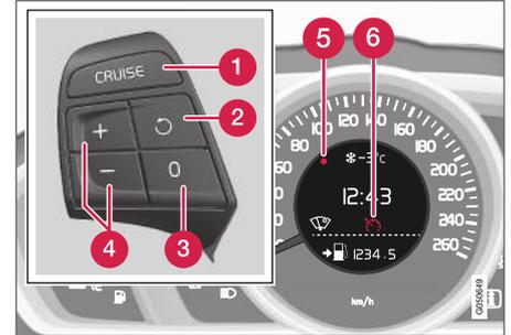
Clavier au volant et écran dans une voiture **sans** limiteur de vitesse<sup>3</sup>.
