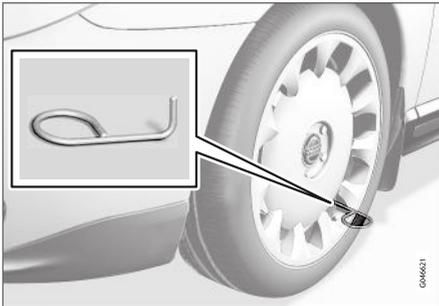
5. Vissez l'œillet de remorquage avec la clé à écrou de roue\* jusqu'en butée.
