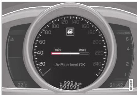
Graphique de niveau AdBlue : chaque repère représente environ 25 % d'un réservoir plein. Lorsqu'il reste moins de 25 % dans le réservoir, le nombre de litres de solution AdBlue pouvant être ajoutés est affiché.
