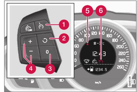
Clavier au volant et écran dans une voiture **avec** limiteur de vitesse<sup>7</sup>.
