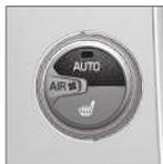
Cette fonction automatique régule automatiquement la température (p. 135), l'air conditionné (p. 136), la vitesse du ventilateur (p. 134), la recirculation (p. 137) et la répartition de l'air (p. 129).
