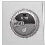
Tournez le bouton de réglage pour augmenter ou réduire la vitesse du ventilateur, le mode **AUTO** est désactivé. Si **AUTO** est sélectionné la vitesse du ventilateur est réglée automatiquement (p. 135) - le réglage de la vitesse du ventilateur est annulé.
