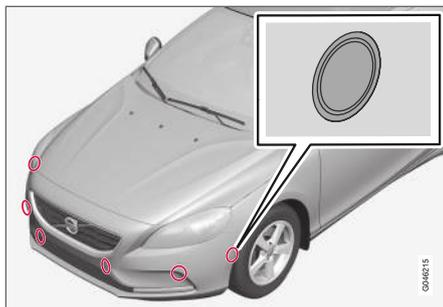
Les capteurs PAP se trouvent dans les pare-chocs<sup>44</sup> : 6 à l'avant et 4 à l'arrière.
