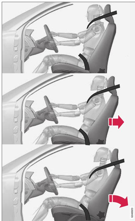
Le système WHIPS est activé en cas de collision par l'arrière en prenant en compte l'angle de la
