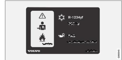
L'autocollant est collé sur la face intérieure du capot moteur.
