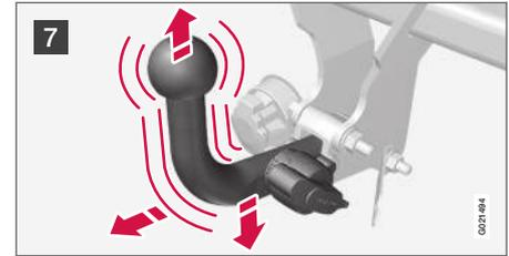
7 Contrôlez que la boule est bien fixée en la frappant vers le haut, le bas et l'arrière.
