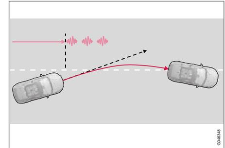
LKA intervient et avertit le conducteur par des vibrations au volant<sup>35</sup>.
