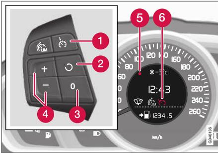
Clavier au volant et combiné d'instruments dans une voiture **avec** limiteur de vitesse<sup>2</sup>.
