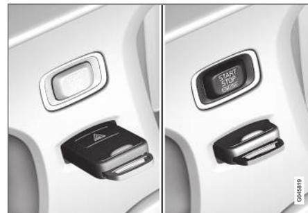
Contacteur d'allumage avec télécommande retirée/insérée.
