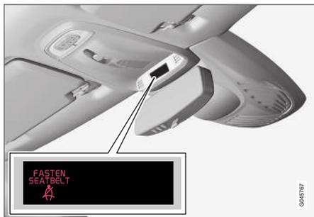
Le rappel sonore dépend de la vitesse et parfois du temps. Le rappel lumineux est situé dans la console du plafond et dans le combiné d'instruments (p. 66).
