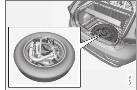
1. Levez le bord arrière du plancher du compartiment à bagages (pour les modèles avec plancher guidé, saisissez la poignée, levez et poussez le plancher vers l'avant).
