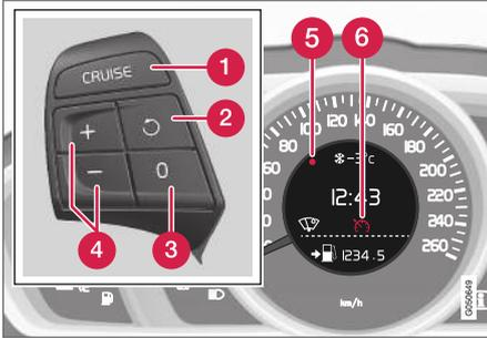
Clavier au volant et écran dans une voiture **sans** limiteur de vitesse<sup>4</sup>.
