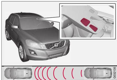
Fenêtre d'émission et de réception du capteur laser<sup>16</sup>.
