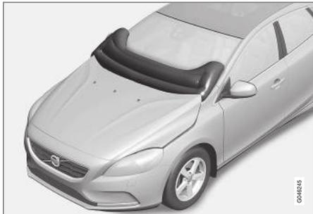
Ce coussin gonflable pour piéton (Pedestrian Airbag) est monté sous le capot moteur, au pied du pare-brise. Dans certaines collisions frontales avec un piéton, les capteurs du pare-chocs avant réagissent et le coussin gonflable est gonflé si la violence de la collision est jugée suffisamment importante. Les capteurs sont actifs à une vitesse d'environ 20 à 50 km/h (12-30 mph) et à une température ambiante comprise entre -20 et +70 °C.
