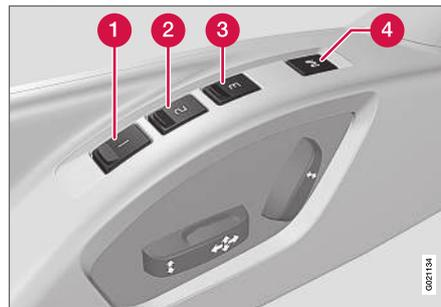
La fonction mémoire enregistre les paramétrages du siège et des rétroviseurs extérieurs.
