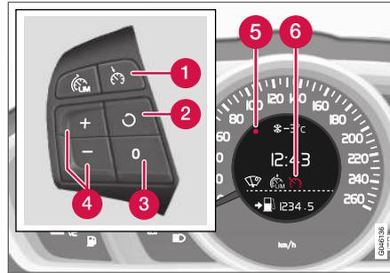
Clavier au volant et écran dans une voiture **avec** limiteur de vitesse<sup>4</sup>.
