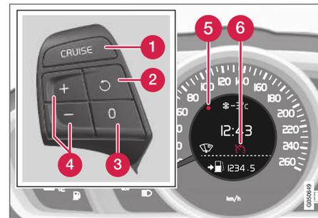
Clavier au volant et combiné d'instruments dans une voiture **sans** limiteur de vitesse<sup>2</sup>.
