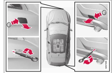
1. Sortez l'œillet de remorquage situé dans le bloc de mousse sous le plancher du compartiment à bagages.
