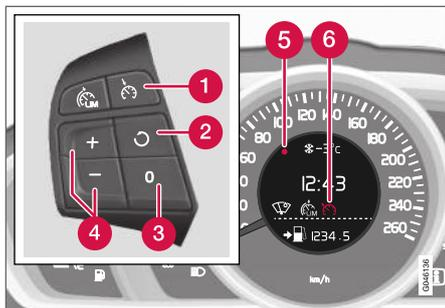
Clavier au volant et écran dans une voiture avec limiteur de vitesse<sup>3</sup>.
