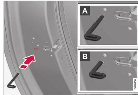
Verrouillage manuel d'une porte. À ne pas confondre avec le Verrouillage de sécurité enfant (p. 181).
