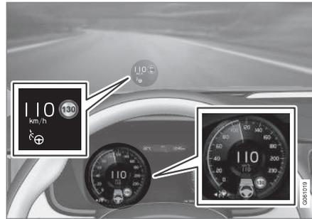
In der obigen Abbildung<sup>49</sup> ist die Funktion Pilot Assist auf 110 km/h (68 mph) eingestellt, und das Fahrzeug kann keinem vorausfahrenden Fahrzeug folgen.
