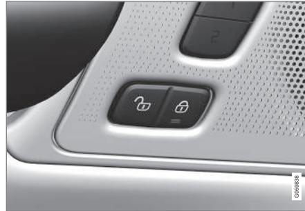
Verriegelungstasten mit Anzeigeleuchte an der Vordertür.
