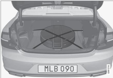
Das Reserverad befindet sich in einem Behälter, der während der Fahrt mit zwei Riemen am Kofferraumboden verzurt sein muss.
