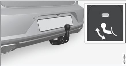
3. Führen Sie die Anhängerkupplung in ihre Endstellung und lassen Sie sie einrasten – die Anzeileuchte leuchtet konstant orange.
