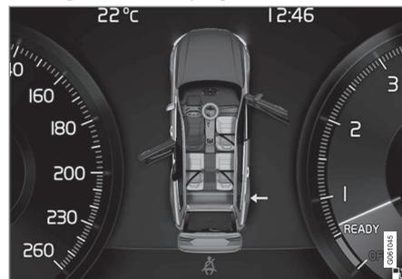
Grafik im Fahrerdisplay mit verschiedenen Arten von Warnungen. Die Warnfarbe an Türe und Kofferraumdeckel ist von der Geschwindigkeit des Fahrzeugs abhängig.
