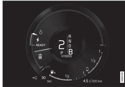
Wenn beim Einsatz der Elektromotor-Bremsfunktion ein Aufladen erfolgt, wird dies auf dem Fahrerdisplay angezeigt.
