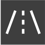
Der Spurassistent wird auf dem Fahrerdisplay von einem Symbol dargestellt, das je nach Situation unterschiedlich aussieht.
