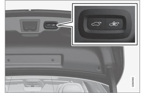
Taste zum Schließen und Verriegeln am unteren Rand des Kofferraumdeckels.
