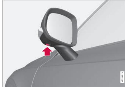
Die Seitenkameras<sup>88</sup> befinden sich in den Seitenspiegeln.
