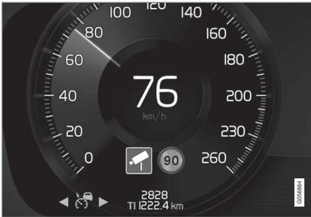
Radarkamera-Warnung auf dem Fahrerdisplay<sup>78</sup>.
