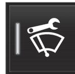
Tippen Sie auf die Taste **Wartungsposition Wischer**. Bei aktivierter Wartungsstellung leuchtet die Anzeigeluchte der Taste. Bei Aktivierung der Funktion werden die Scheibenwischer gerade nach
