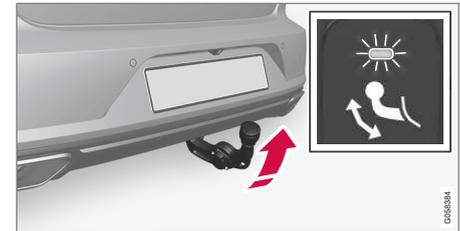
2. Drücken Sie den Schalter und lassen Sie ihn wieder los. Ein zu langes Drücken des Schalters kann dazu führen, dass der Ausklappvorgang nicht gestartet wird.
