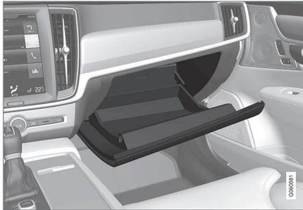
Im Handschuhfach können Sie beispielsweise die gedruckte Betriebsanleitung des Fahrzeugs oder Straßenkarten aufbewahren. Innen an der Klappe befindet sich ein Stifthalter. Am oberen Rand des Handschuhfachs befindet sich außerdem eine Kartenhalterung.
