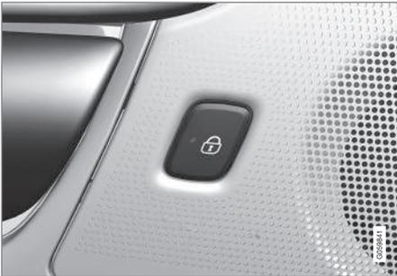
Verriegelungstaste mit Anzeigeleuchte an der Hintertür.
