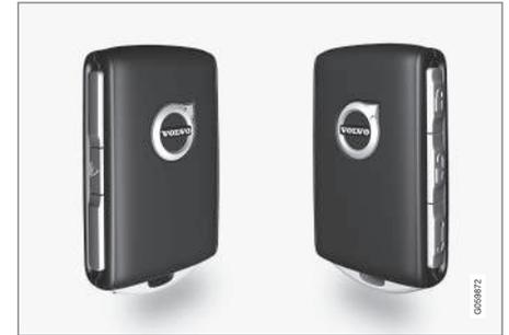
Mit den Tasten am Transponderschlüssel können Sie alle Türen und dem Kofferraumdeckel gleichzeitig ver- und entriegeln.
