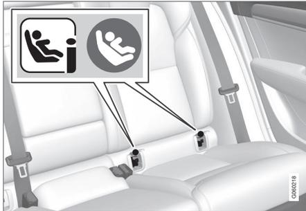
Sie erkennen die Befestigungspunkte an den Symbolen<sup>4</sup> hinten an der Rückenlehne.
