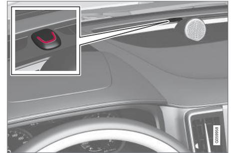
Eine rote Leuchtdiode am Armaturenbrett zeigt den Status der Alarmanlage an:
