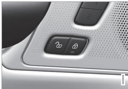
Ver- und Entriegelungstaste mit Anzeigeleuchte an der
