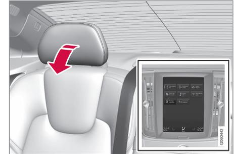
Die Kopfstützen der Außensitze können auf zweierlei Weise über das Center Display umgeklappt werden:
