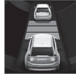
Es können verschiedene Zeitabstände zum vorausfahrenden Fahrzeug eingestellt und auf dem Fahrerdisplay als 1-5 horizontale Linien angezeigt werden – je mehr Linien, desto größer der Zeitabstand. Eine
