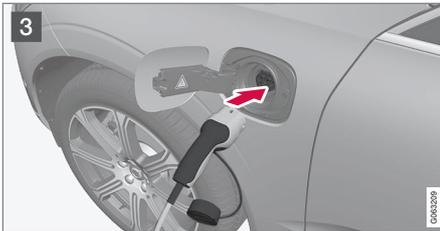
3 Die Ladeklappe öffnen. Schutzverschluss des Ladestutzens abziehen und dann den Stutzen ganz in den Anschluss des Fahrzeugs einführen.
