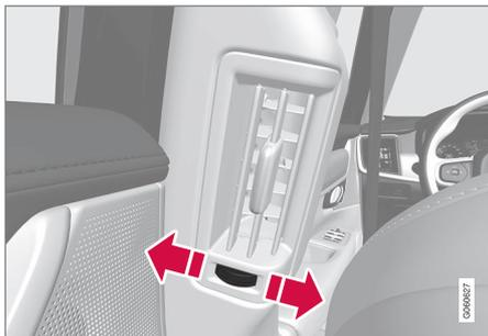
Stellrad der Belüftungsdüse<sup>1</sup>.
