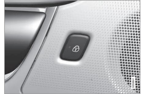
Verriegelungstaste mit Anzeigeleuchte an der Fondtür.
