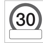
Ein Symbol für ein Zusatzschild in Form eines leeren Rahmens unter dem Geschwindigkeitsymbol<sup>73</sup> im Fahrerdisplay bedeutet, dass das RSI ein Zusatzschild mit zusätzlichen Informationen zur aktuellen
