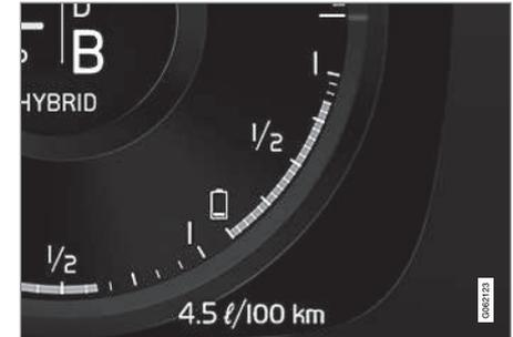
Die Hybridbatterie-Anzeige zeigt die in der Batterie verfügbare Energiemenge an. Diese Energie wird vom Elektromotor, aber auch zum Kühlen oder Heizen des Fahrzeugs genutzt.
