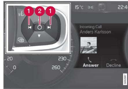
Meldung auf dem Fahrerdisplay und rechtes Lenkradtastentfeld.
