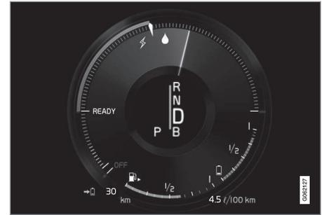
Fahrerdisplay bei Antriebs durch Elektro- und Verbrennungsmotor.
