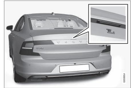
Die gummierte Druckplatte am Griff des Kofferraumdeckels dient ausschließlich der Entriegelung.
