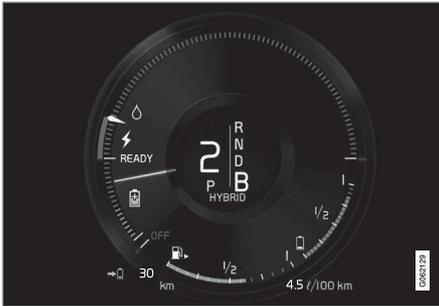
Das Fahrzeug erzeugt Strom für die Batterie, die aufgeladen wird, z. B. bei einem leichten Druck auf das Bremspedal oder beim Einsatz der Motorbremse bei einer Bergabfahrt.
