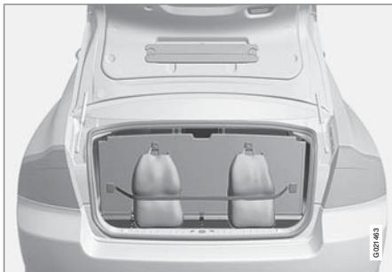
Le dispositif de retenue pour sacs à provisions maintient les sacs en place et empêche ceux-ci de se retourner et leur contenu de se répandre dans le compartiment à bagages.
