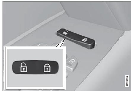
Avec les boutons situés sur le panneau de porte, il est possible de verrouiller et de déverrouiller simultanément toutes les portes et le coffre à bagages.
