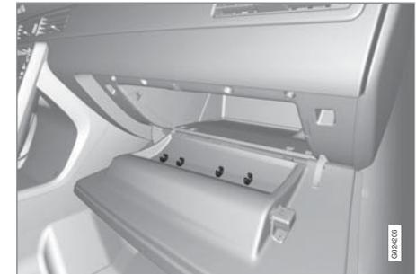
Le manuel de conduite et d'entretien et les cartes routières par exemple peuvent être rangés à cet endroit. Il y a un porte-stylo sur la face intérieure de la porte de la boîte à gants. La boîte à gants peut être verrouillée avec la lame de clé, voir page 43.
