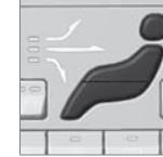
La figure est composée de trois boutons. En appuyant sur le boutons, un témoin s'allume devant chaque partie de la figure, indiquant la répartition de l'air sélectionnée, voir page 130.
