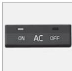
La climatisation est contrôlée automatiquement par le système lorsque la diode **ON** est allumée. Dans ce cas, l'air entrant est refroidi et déshumidifié.
