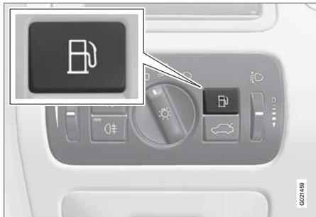
La trappe du réservoir de carburant est déverrouillée et ouverte grâce au bouton du panneau d'éclairage. La trappe du réservoir est située sur l'aile arrière droite, ce que la flèche
