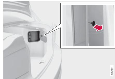
La trappe du réservoir de carburant peut être ouverte à la main lorsque l'ouverture électrique depuis l'habitacle n'est pas possible.
