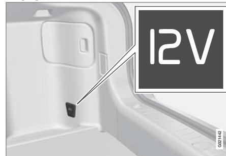
Repliez le cache vers le bas pour accéder à la prise électrique. La prise fonctionne que le contact soit mis ou non.
