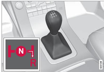
Le verrouillage de marche arrière réduit le risque de passer la marche arrière par erreur lorsque vous roulez normalement en marche avant.
