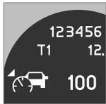
Un symbole à la forme d'une voiture s'allume sur le côté gauche de l'écran lorsque le radar a détecté un autre véhicule. La distance au véhicule qui vous précède n'est réglée que lorsque le témoin est
