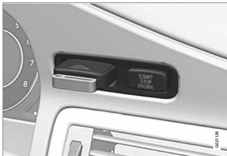
Interrupteur de contact avec télécommande, bouton start/stop.
