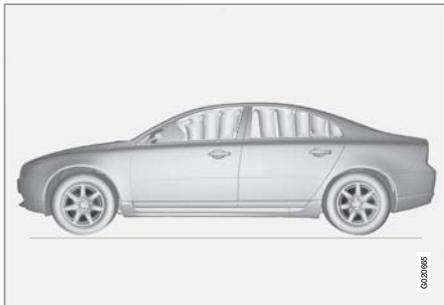
Le rideau gonflable IC (Inflatable Curtain) est un complément aux coussins gonflables SIPS et SRS. Le rideau gonflable est dissimulé dans la garniture de plafond des deux côtés de la voiture et il protège toutes les places extérieures. Lors d'une forte collision, les capteurs réagissent et le rideau gonflable se gonfle. Le rideau gonflable a été conçu pour empêcher la tête du conducteur et des passagers de heurter l'intérieur de la voiture en cas de collision.
