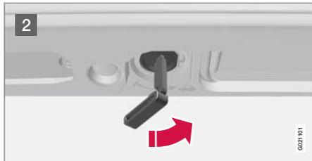
Si le bouton d'ouverture du coffre à bagages de la télécommande est hors service, la coffre à bagages peut être déverrouillé avec la lame de clé.
