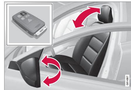
Lorsque la voiture est déverrouillée avec la même télécommande, le siège conducteur et les rétroviseurs extérieurs reprennent les positions mémorisées dans la mémoire clé dès l'ouverture de la porte conducteur.
