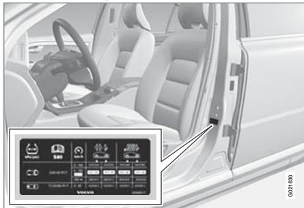
L'autocollant de pressions de pneu sur le montant de porte du côté conducteur (entre les portes avant et arrière) indique quelle pression les pneus doivent avoir à différentes conditions de charge et de vitesse. La pression correcte est aussi indiquée dans le tableau de pressions de pneu, voir ci-dessous.
