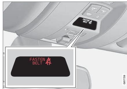
Un rappel lumineux et sonore incite les personnes qui n'ont pas bouclé leur ceinture de sécurité à le faire. Le rappel sonore dépend de la vitesse et parfois du temps. Le rappel lumineux est situé dans la console du plafond et dans le combiné d'instruments.
