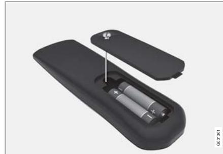
1. Desserrez la vis et retirez le couvercle de pile.
