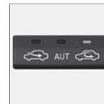
Lorsque la recirculation est activée, la diode orange droite du bouton s'allume. Cette fonction est sélectionnée pour isoler l'habitacle de l'air vicié extérieur, des gaz d'échappements etc. L'air est
