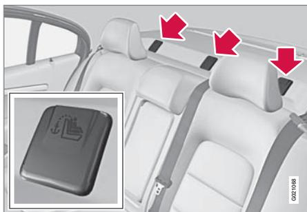
La voiture est équipée de points de fixations supérieure pour sièges enfant. Ces points de fixation sont placés sur la plage arrière et
