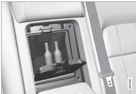
Il se trouve derrière l'accoudoir de la banquette arrière et a une contenance de 11,5 litres. Le réfrigérateur fonctionne toujours lorsque le moteur tourne ou que la télécommande est en position II et il est hors fonction lorsque le moteur est à l'arrêt.
