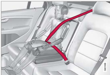
Le coussin rehausseur intégré Volvo sur la place centrale de la banquette arrière est spécialement conçu pour offrir une parfaite sécurité aux enfants. Combiné à la ceinture de
