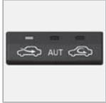
Le système de qualité de l'air permet de séparer les gaz et les particules pour réduire les mauvaises odeurs et les polluants dans l'habitacle. Si l'air extérieur est vicié, l'arrivée d'air est fermée et l'air est
