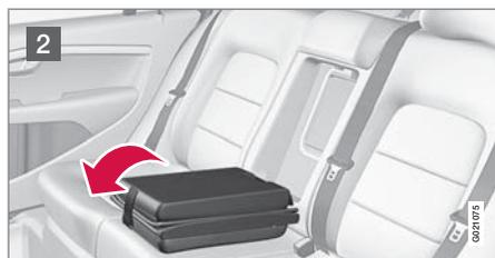
2 Fissare il nastro in velcro.
