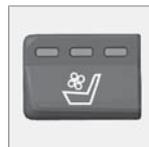
La ventilazione dei sedili anteriori è possibile solo se l'automobile è dotata di ECC. Il sistema di ventilazione è costituito da ventole integrate nel sedile e nello schienale che aspirano l'aria attraverso il rivestimento del sedile. La capacità di raffreddamento aumenta mano a mano che l'aria nell'abitacolo si raffredda.
