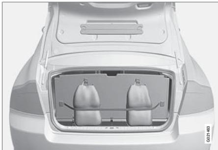
Il supporto per borse della spesa mantiene in posizione le borse impedendone il rovesciamento nel bagagliaio.
