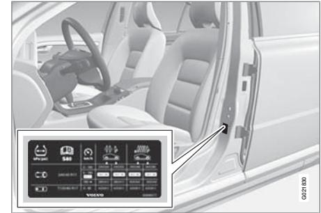
L'etichetta pressione pneumatici sul montante della portiera del conducente (tra portiera anteriore e posteriore) indica le pressioni dei pneumatici richieste in base al carico e alla velocità. Le pressioni dei pneumatici sono riportate anche nella tabella delle pressioni pneumatici, vedere di seguito.
