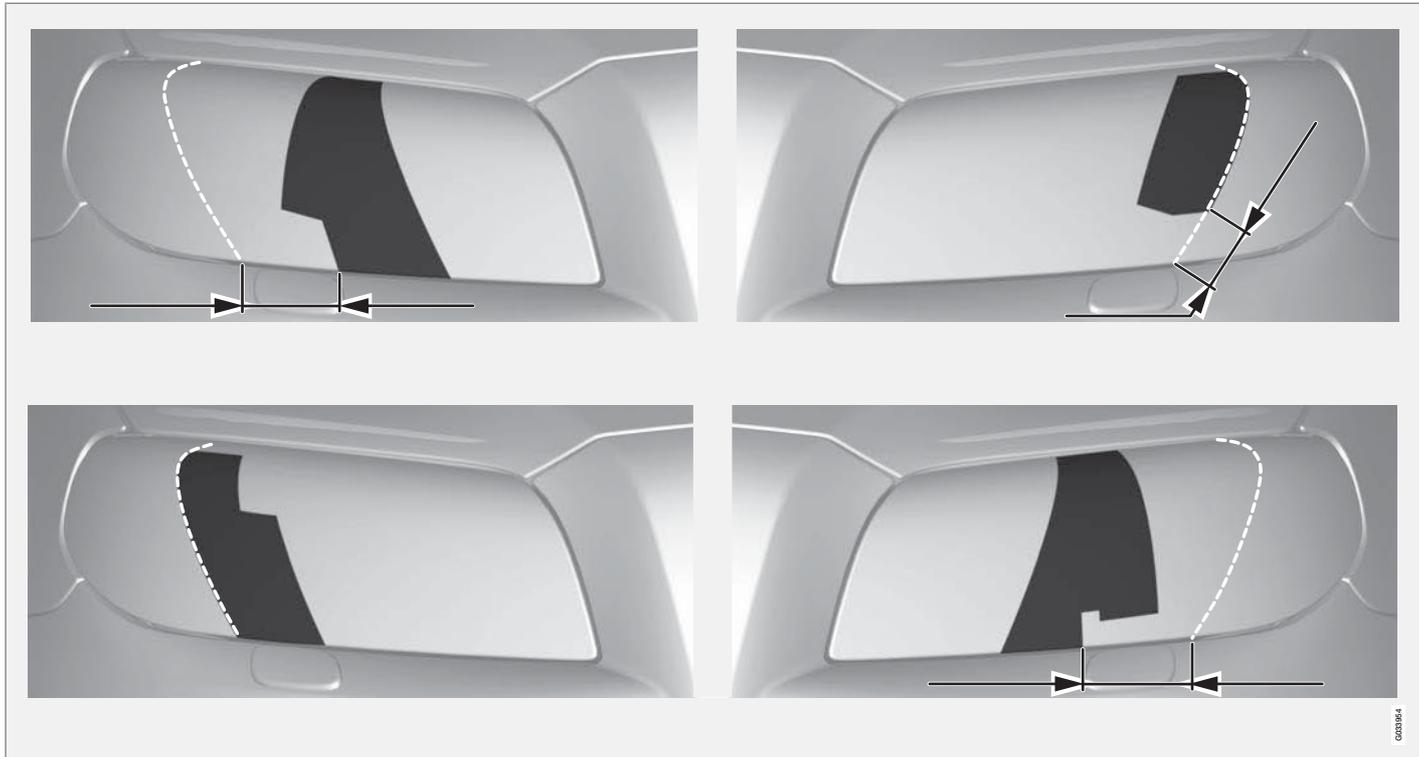
Riga superiore: maschera per un'automobile con guida a sinistra, sagome A e B. Riga inferiore: maschera per un'automobile con guida a destra, sagome C e D.
