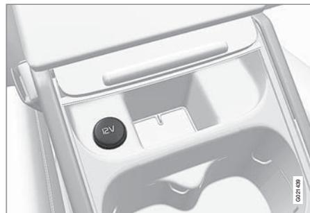
*Presenza da 12 V nel tunnel, sedile anteriore.*
