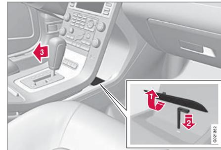
Se non è possibile guidare l'automobile, ad esempio perché la batteria di avviamento è scarica, occorre deselegnare la posizione **P** della leva selettoria per spostare l'automobile.
