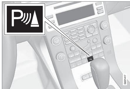
Il sistema si attiva automaticamente quando si avvia l'automobile e la spia On/Off sull'interuttore si accende. Disattivando l'assistenza al parcheggio con il pulsante, la spia si spegne.
