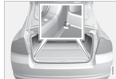
Gli occhielli fermacarico ripiegabili si utilizzano per fissare le cinghie che mantengono fermi gli oggetti nel bagagliaio
