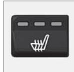
Premendo il pulsante una volta si ottiene il livello di riscaldamento max – 3 spie accese.
