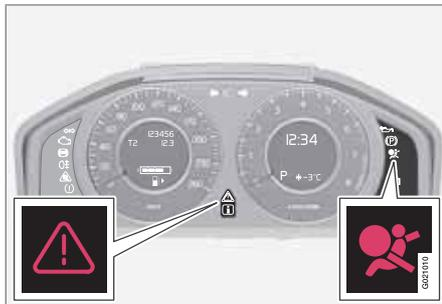
El símbolo de advertencia en el instrumento combinado se enciende con la llave en la posición II o III. El símbolo se apaga después de 6 segundos si el sistema de airbags no tiene averías.
