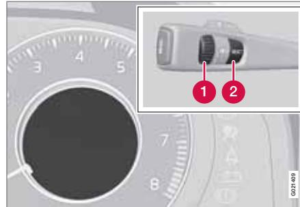
1. Gire la rueda selectora (1) hasta que aparezca el menú **DSTC**. **DSTC ON** significa que la función del sistema no ha sufrido cambios.
