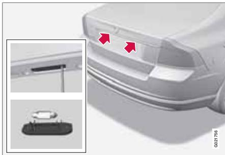
1. Suelte los tornillos con un destornillador.
