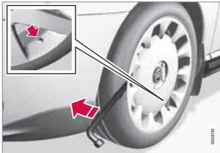
Si el automóvil tiene tapacubos de cobertura total, éstos deben desmontarse.
