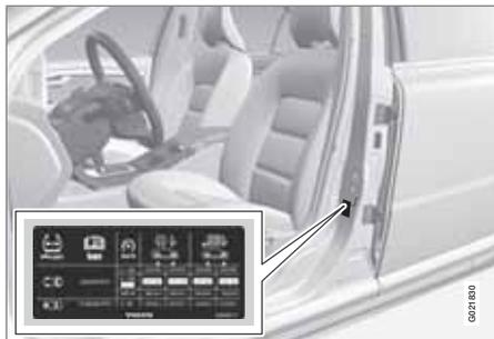
La placa de presión de neumáticos situada en el montante de la puerta del lado del conductor (entre la puerta delantera y la trasera) especifica la presión que deben tener los neumáticos en diferentes condiciones de carga y velocidad. Esos datos se indican asimismo en la tabla de presiones de neumáticos, ver la página 313.
