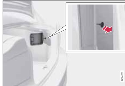
La tapa del depósito puede abrirse manualmente cuando no sea posible abrirlo por vía eléctrica en el habitáculo.
