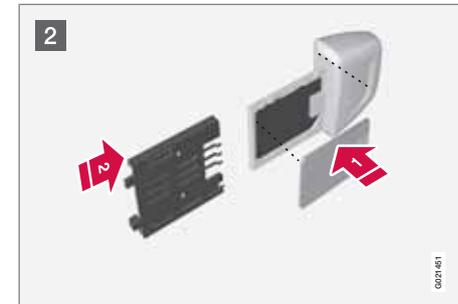
**1** Asegúrese de que el teléfono está desconectado. Extraiga el soporte de la tarjeta SIM situada en la guantera.
