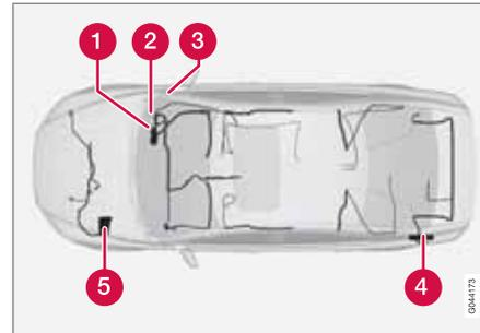
Si el automóvil tiene el volante a la derecha, las cajas de fusibles situadas debajo de la guantera cambian de lado.
