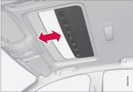
Mit einem langen Druck auf die Verriegelungstaste werden das Schiebedach und sämtliche Fenster geschlossen, siehe Transponderschlüssel - Funktionen (S. 158) und Verriegelung/Entriegelung - von innen (S. 172). Türen und Kofferraumdeckel werden verriegelt. Wenn der Schließvorgang unterbrochen werden muss, erneut auf die Verriegelungstaste drücken.
