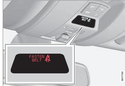
Das akustische Signal ist geschwindigkeitsabhängig und in bestimmten Fällen zeitabhängig. Das optische Signal befindet sich in der Dachkonsole und im Kombinationsinstrument (S. 56).
