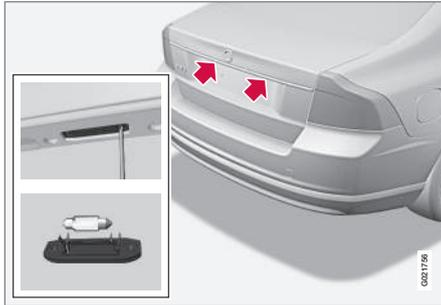
1. Die Schrauben mit einem Schraubendreher lösen.
