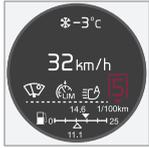
Bei einem "analogen" Kombinationsinstrument werden die Schaltstellung und die Anzeigepfeile in der Mitte des Instruments angezeigt.
