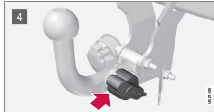
**4** Die Anhängerzugvorrichtung einsetzen und hineinschieben, bis ein Klicken zu hören ist.
