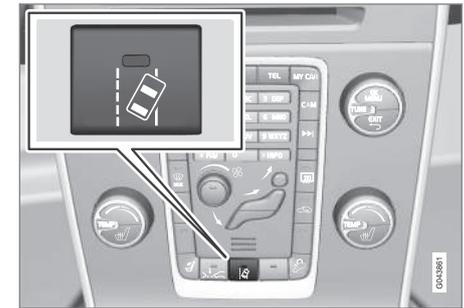
LDW wird mit einer Taste auf der Mittelkonsole ein- bzw. ausgeschaltet. Eine Lampe in der Taste leuchtet, wenn die Funktion eingeschaltet ist.
