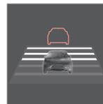
Es können verschiedene Zeitabstände zum vorausfahrenden Fahrzeug eingestellt und im Kombiinstrument als 1–5 horizontale Linien angezeigt werden – je mehr Linien, desto größer
