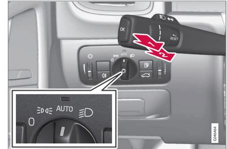
Lenkradhebel und Lichtschalter-Drehregler.
