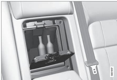
Hinter der Armlehne im Fond befindet sich eine Kühlbox. Die Box wird gekühlt, wenn der Motor läuft oder der Transponderschlüssel in Stellung II steht.
