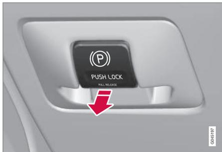
Feststellbremsregler - lösen.
