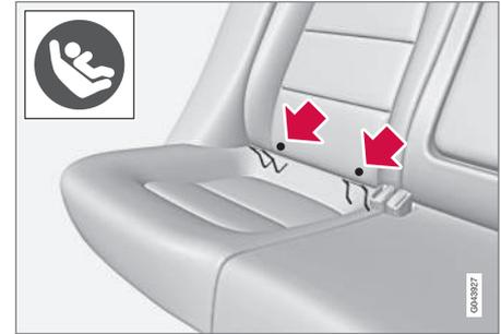
Die Befestigungspunkte für das ISOFIX-Befestigungssystem sind hinter dem unteren Teil der Rückenlehne im Fond, in den äußeren Sitzplätzen, verborgen.
