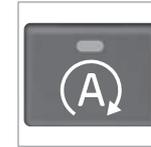
In bestimmten Situationen ist es wünschenswert, die automatische Start/Stop-Funktion vorübergehend ausschalten zu können – dies erfolgt mit einem Druck auf diese Taste.
