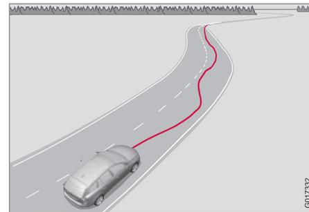
Eine Kamera erfasst die gemalten Seitenmarkierungen der Fahrbahn und vergleicht die Straßenführung mit den Lenkradbewegungen des Fahrers. Der Fahrer wird gewarnt, wenn das Fahrzeug der Fahrbahn nicht auf gleichmäßige Weise folgt.
