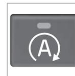
Die Start/Stop-Funktion wird automatisch aktiviert, wenn der Motor mit dem Schlüssel gestartet wird. Der Fahrer wird darauf aufmerksam gemacht, indem das Symbol der Funktion im Kombinationsinstrument aufleuchtet und die Lampe in der Ein-/Aus-Taste leuchtet.
