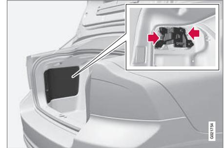
Die Lampen in der Heckleuchte werden vom Kofferraum aus ausgetauscht (nicht die LED-Lampen).
