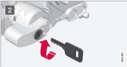
**2** Überprüfen, ob sich der Mechanismus in der unverriegelten Stellung befindet. Dazu den Schlüssel im Uhrzeigersinn drehen.
