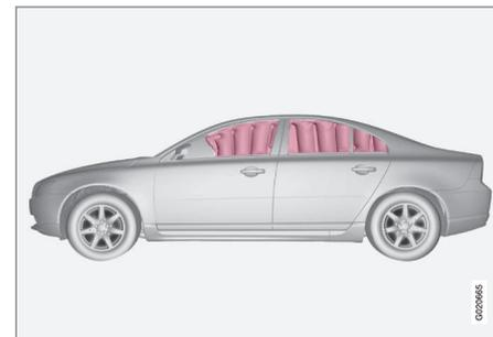
Der Kopf-/Schulterairbag (Inflatable Curtain) ist ein Teil des SIPS-Systems (S. 30) und des Airbagsystems (S. 26). Der Kopf-/Schulterairbag ist im Dachhimmel entlang der Seiten des Fahrzeugs verborgen. Er schützt die Insassen auf den Außenplätzen des Fahrzeugs. Bei einem ausreichend starken Aufprall reagieren die Sensoren und der Kopf-/Schulterairbag wird aufgeblasen.
