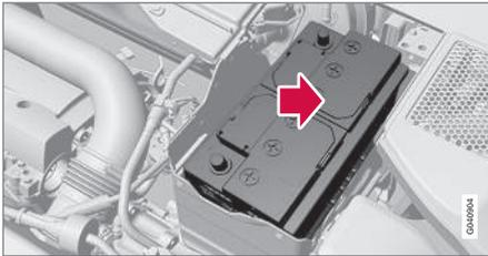
1. Die Batterie in den Batteriekasten stellen.
