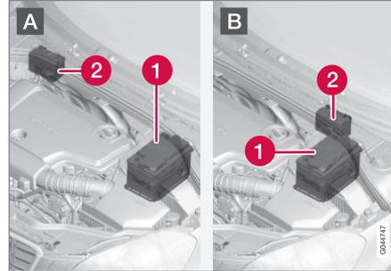
A: Linkslenker. B: Rechtslenker. (1) Startbatterie<sup>12</sup> (2) Unterstützungsbatterie.
