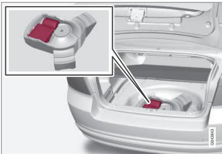
Der Reifenabdichtsatz ist unter dem Kofferraumboden verstaut.
