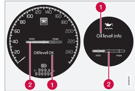
Mitteilung und Graph im Display. Links ist das digitale, rechts das analoge Kombinationsinstrument dargestellt.
