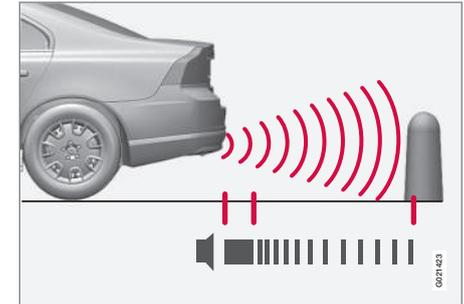
Der Messbereich in gerader Richtung hinter dem Fahrzeug liegt bei ca. 1,5 m. Das Tonsignal für Hindernisse hinter dem Fahrzeug kommt aus einem der hinteren Lautsprecher.
