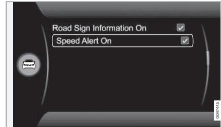
Der Fahrer kann auf Wunsch eine Warnung erhalten, wenn die geltende Geschwindigkeitsbegrenzung um 5 km/h oder mehr überschritten wird. Die Warnung zeigt sich dadurch, dass das Symbol mit der geltenden Höchstgeschwindigkeit bei Überschreitung der Geschwindigkeit blinkt. Die Funktion kann im Menüsystem **MY CAR** aktiviert/deaktiviert werden. Mehr zur Beschreibung des Menüsystems siehe MY CAR (S. 107).
