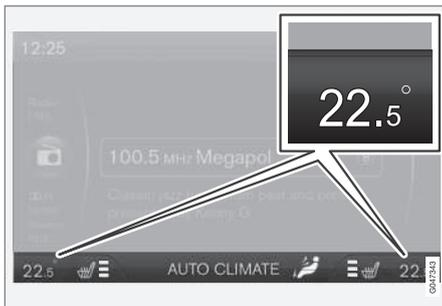
Die aktuelle Temperatur für jede Seite wird auf dem Bildschirm der Mittelkonsole angezeigt.
