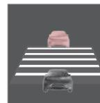
Nur wenn das Symbol das Bild eines anderen Fahrzeugs zeigt, wird der **Abstand** zum vorausfahrenden Fahrzeug durch den Tempomat reguliert.
