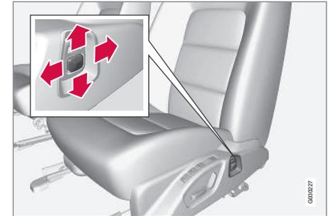
Taste zur Einstellung der Lendenwirbelstütze.
