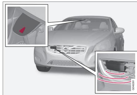
Kamera- und Radarsensor<sup>22</sup>.
