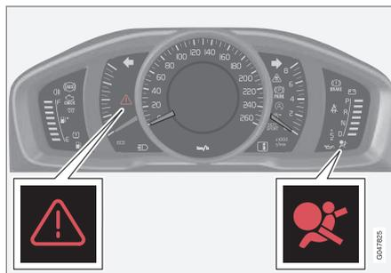
Warndreieck und Warnsymbol für das Airbagsystem (S. 26) im analogen Kombiinstrument.
