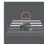
Es können verschiedene Zeitabstände zum vorausfahrenden Fahrzeug eingestellt und im Kombinationsinstrument als 1–5 horizontale Linien angezeigt werden – je mehr Linien, desto größer
