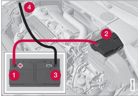
Wenn eine andere Batterie zur Starthilfe verwendet wird, werden folgende Schritte empfohlen, um einen Kurzschluss oder andere Schäden zu vermeiden:
