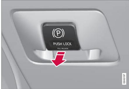
Feststellbremsregler - lösen.
