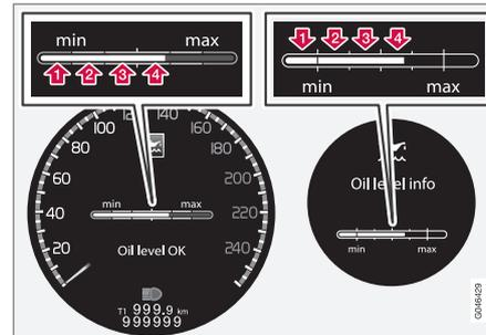
Die Zahlen 1–4 stehen für den Füllstand. Kein Öl mehr einfüllen, wenn der Füllstand (3) oder (4) angezeigt wird. Der empfohlene Füllstand ist 4. Mitteilung und Graph im Display. Links ist das digitale, rechts das analoge Kombinationsinstrument dargestellt.
