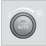
Mit dem Drehregler wird die Gebläsegeschwindigkeit erhöht oder gesenkt. Bei der Wahl von **AUTO** wird die Gebläsegeschwindigkeit automatisch (S. 136) geregelt - die zuvor eingestellte
