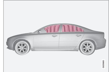
Der Kopf-/Schulterairbag (Inflatable Curtain) ist ein Teil des SIPS-Systems (S. 34) und des Airbagsystems (S. 29). Der Kopf-/Schulterairbag ist im Dachhimmel entlang der Seiten des Fahrzeugs verborgen. Er schützt die Insassen auf den Außenplätzen des Fahrzeugs. Bei einem ausreichend starken Aufprall reagieren die Sensoren und der Kopf-/Schulterairbag wird aufgeblasen.
