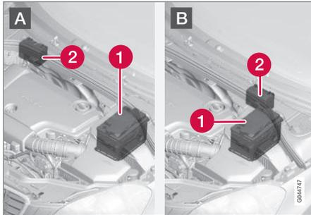
A: Linkslenker. B: Rechtslenker. (1) Startbatterie<sup>14</sup> (2) Unterstützungsbatterie.
