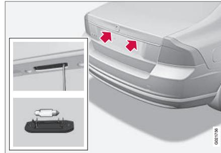
1. Die Schrauben mit einem Schraubendreher lösen.
