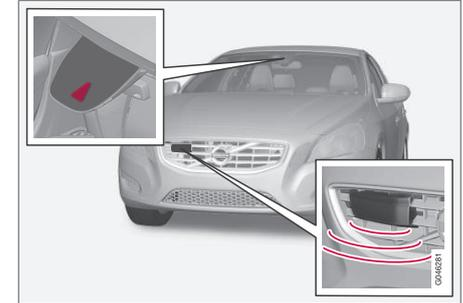
*Kamera- und Radarsensor<sup>24</sup>.*
