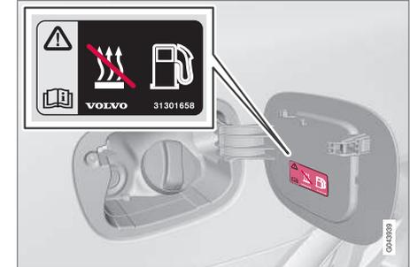
Bei hohen Außentemperaturen kann ein Überdruck im Tank entstehen. Den Verschluss in diesem Fall langsam öffnen.
