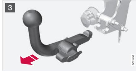
3 Den Verriegelungsknopf vollständig bis zum Anschlag weiterdrehen, herunterdrücken und gleichzeitig die Anhängerzugvorrichtung nach hinten und oben herausziehen.
