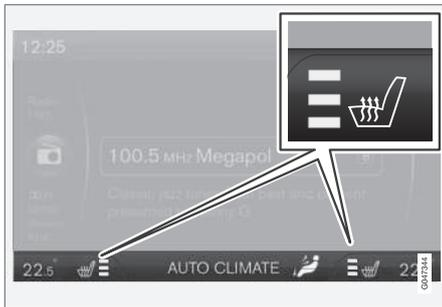
Die aktuelle Heizleistung wird am Bildschirm der Mittelkonsole angezeigt.
