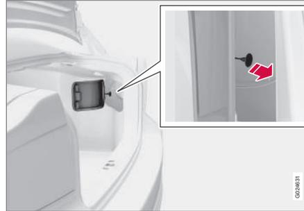
1. Die Seitenklappe im Kofferraum öffnen/entfernen (auf derselben Seite wie die Tankklappe) und nach einem grünen Seilzug mit Griff tasten.
