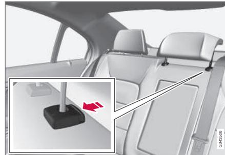
Die Kopfstütze an die Körpergröße des Insassen anpassen. Die obere Kante der Kopfstütze sollte zur Mitte des Hinterkopfes aus-
