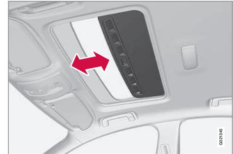
Mit einem langen Druck auf die Verriegelungstaste werden das Schiebedach und sämtliche Fenster geschlossen, siehe Transponderschlüssel - Funktionen (S. 165) und Verriegelung/Entriegelung - von innen (S. 178). Türen und Kofferraumdeckel werden verriegelt. Wenn der Schließvorgang unterbrochen werden muss, erneut auf die Verriegelungstaste drücken.
