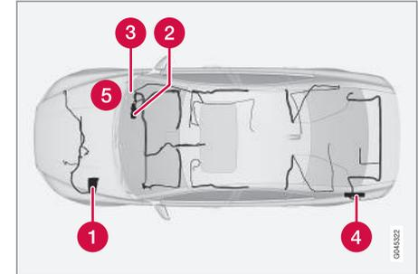
Position der Zentralelektriken in Fahrzeugen mit Linkslenkung, bei Rechtslenkung wechseln die Zentralelektriken unter dem Handschuhfach die Seite.
