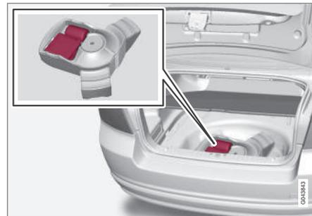
Der Reifenabdichtungsatz ist unter dem Kofferraumboden verstaut.
