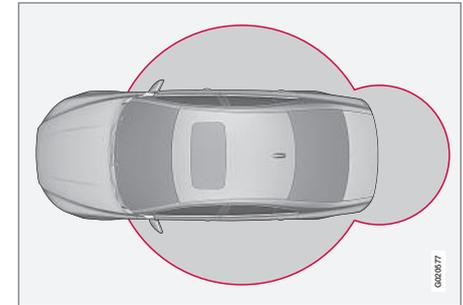
Die grauen Kreise in der obenstehenden Abbildung illustrieren den Bereich, der von den Antennen des Systems abgedeckt ist.
