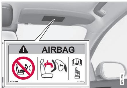
Möglichkeit 1: Airbagaufkleber an der Sonnenblende auf Beifahrerseite.
