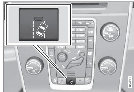
LDW wird mit einer Taste auf der Mittelkonsole ein- bzw. ausgeschaltet. Eine Lampe in der Taste leuchtet, wenn die Funktion eingeschaltet ist.
