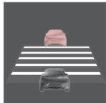
Nur wenn das Symbol das Bild eines anderen Fahrzeugs zeigt, wird der **Abstand** zum vorausfahrenden Fahrzeug durch den ACC reguliert.
