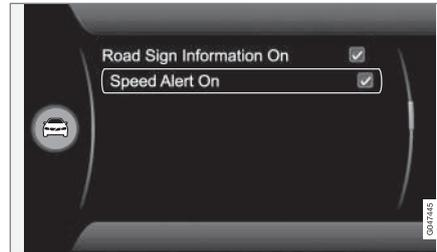
Der Fahrer kann auf Wunsch eine Warnung erhalten, wenn die geltende Geschwindigkeitsbegrenzung um 5 km/h oder mehr überschritten wird. Die Warnung zeigt sich dadurch, dass das Symbol mit der geltenden Höchstgeschwindigkeit bei Überschreitung der Geschwindigkeit blinkt. Die Funktion kann im Menüsystem **MY CAR** aktiviert/deaktiviert werden. Mehr zur Beschreibung des Menüsystems siehe MY CAR (S. 113).
