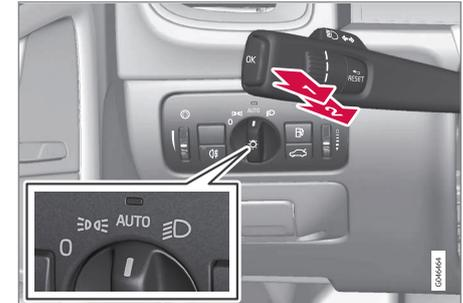
Lenkradhebel und Lichtschalter-Drehregler.
