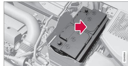
1. Die Batterie in den Batteriekasten stellen.
