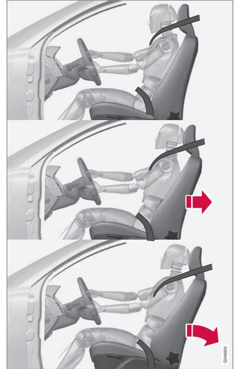
Das WHIPS-System wird bei einem Heckaufprall aktiviert, wobei Aufprallwinkel, Geschwindigkeit und Eigenschaften des auf-fahrenden Fahrzeugs ausschlaggebend sind.
