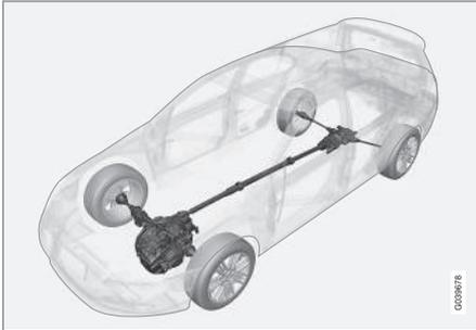
Fahrzeuge mit Allradantrieb (All Wheel Drive) werden von allen vier Rädern gleichzeitig angetrieben.
