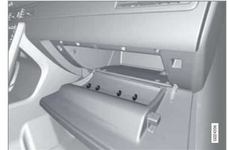
Hier können beispielsweise die Betriebsanleitung des Fahrzeugs und Straßenkarten aufbewahrt werden. Auf der Innenseite der Klappe ist ein Halter für Stifte vorhanden. Das Handschuhfach kann verriegelt (S. 179)\* werden, indem das Schlüsselblatt (S. 169) verwendet wird.
