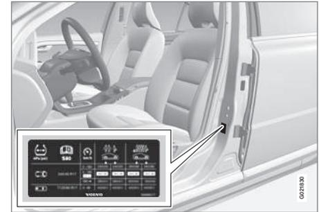
Auf dem Reifendruckaufkleber an der Türsäuleninnenseite auf der Fahrerseite (zwischen Vorder- und Fondtür) ist der bei unterschiedlicher Beladung und unterschiedlichen Geschwindigkeitsverhältnissen geltende Reifendruck angegeben. Der Reifendruck ist außerdem in der Reifendrucktabelle angegeben, siehe Reifen - zugelassener Reifendruck (S. 430).
