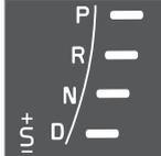
Automatische Gangstellungen werden rechts auf dem Kombinationsinstrument angezeigt (jeweils nur eine Markierung leuchtet - die für die aktuelle Wählhebelstellung.)
