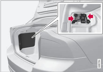
Die Lampen in der Heckleuchte werden vom Kofferraum aus ausgetauscht (nicht die LED-Lampen).
