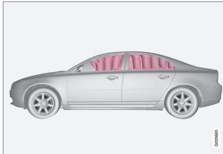
La tendina gonfiabile IC (Inflatable Curtain) fa parte del sistema SIPS (p. 38) e del sistema airbag (p. 33). È montata lungo entrambi i bordi del rivestimento del padiglione e contribuisce a proteggere il conducente ed i passeggeri dei sedili esterni. In caso di collisione sufficientemente forte, i sensori reagiscono gonfiando la tendina gonfiabile.
