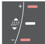
Indicatore cambio di marcia per cambio manuale. È acceso un solo indicatore alla volta; durante la guida normale è acceso solo quello al centro.
