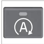
Tutti i normali impianti dell'automobile (illuminazione, radio ecc.) funzionano regolarmente anche allo spegnimento automatico del motore, ma alcune funzioni possono essere temporaneamente ridotte, ad esempio la velocità della ventola del climatizzatore o il volume dell'impianto audio se è molto alto.
