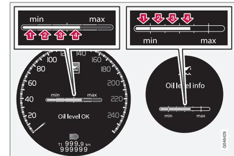
I numeri 1-4 indicano il livello di riempimento. Non rabboccare olio se è visualizzato il livello di riempimento (3) o (4). Il livello di riempimento raccomandato è il 4. Messaggio e grafico sul display. Il display sinistro è visualizzato nel quadro strumenti digitale e quello destro nel quadro strumenti analogico.
