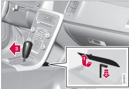
Se non è possibile guidare l'automobile, ad esempio perché la batteria di avviamento è scarica, occorre uscire dalla posizione **P** della leva selettore per spostare l'automobile.
