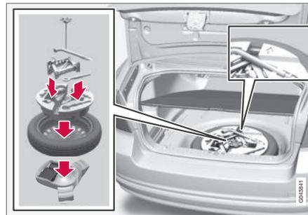
Sotto il pianale di carico sono riposti l'occhiello di traino, il martinetto\* e la chiave per le colonnette\*. Qui c'è anche spazio per il chiave delle colonnette bloccabili e l'attrezzo per i cappucci di plastica delle colonnette.
