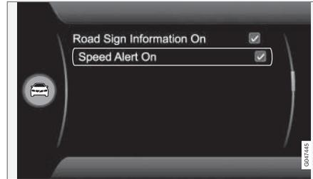
Il conducente può attivare un avvertimento che viene fornito qualora si superi il limite di velocità di 5 km/h (5 mph) o più. L'avvertimento è rappresentato dal lampeggio del simbolo del limite di velocità per tutto il tempo in cui detta velocità è superata. La funzione può essere attivata/disattivata nel menu **MY CAR**. Per la descrizione del menu, vedere MY CAR (p. 115).
