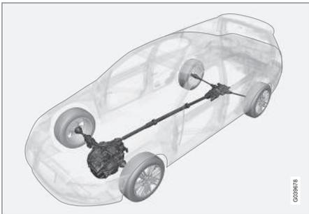
La trazione integrale (All Wheel Drive) agisce contemporaneamente sulle quattro ruote.
