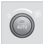
Ruotare la manopola per aumentare o ridurre la velocità della ventola. Se si seleziona **AUTO**, la velocità della ventola si regola automaticamente (p. 138) - la velocità della ventola precedentemente impostata viene disinserita.
