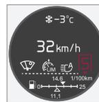
Con il quadro strumenti "Analog" sono visualizzati al centro di esso le posizioni del cambio e le frecce indicatrici.
