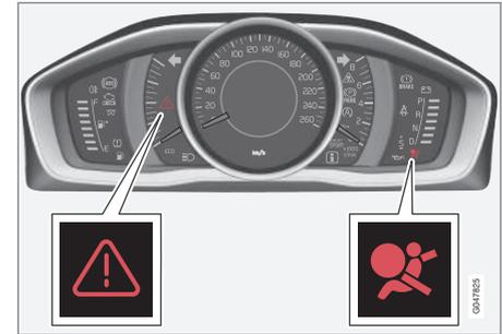
Triangolo di avvertimento e spia di allarme del sistema airbag (p. 33) nel quadro strumenti analogico.
