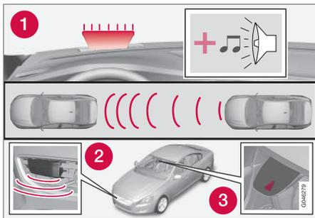
1. Spia di allarme e segnale acustico dell'indicatore di collisione<sup>6</sup>.
