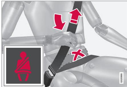
*Tendere la sezione lombare sui fianchi tirando la sezione diagonale in alto verso la spalla. La sezione lombare deve rimanere bassa (non sopra l'addome).*
