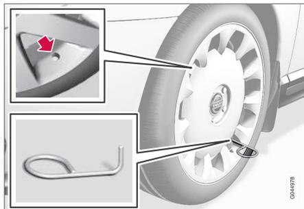
5. Avvitare a fondo l'occhiello di traino con la chiave per le colonnette delle ruote\*.
