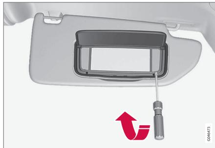
1. Inserire un cacciavite sotto la lente della lampadina e sollevare con cautela i fermi sul bordo.
