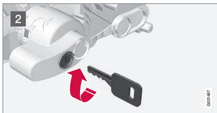
2 Compruebe que el mecanismo está en posición de apertura girando la llave hacia la derecha.
