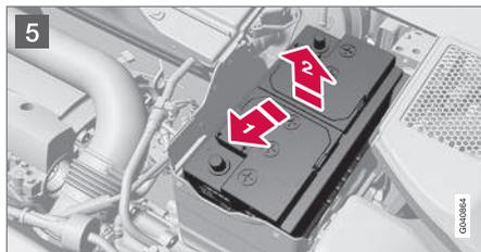
**1** Abra los clips de la tapa de protección delantera y suelte la tapa.
