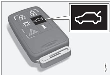
Con el botón
