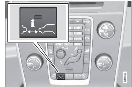
Pulse el botón de la consola central para conectar o desconectar la función. La luz del botón encendida indica que la función está conectada.
