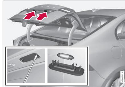
1. Suelte los tornillos con un destornillador.
