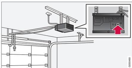
4. Busque el "botón de memorización<sup>27</sup>" en el receptor de, por ejemplo, la puerta del garaje, que suele estar situado cerca de la fijación de la antena en el receptor.
