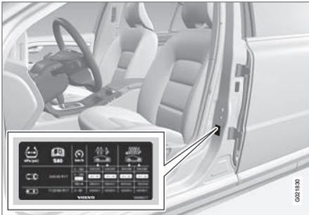
La placa de presión de neumáticos situada en el montante de la puerta del lado del conductor (entre la puerta delantera y la trasera) especifica la presión que deben tener los neumáticos en diferentes condiciones de carga y velocidad. Estos datos se indican también en la tabla de presiones de neumáticos, véase Neumáticos - presiones de inflado aprobadas (p. 443).
