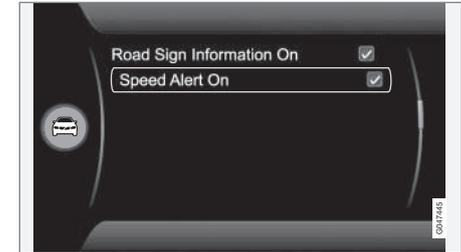
El conductor puede optar por recibir una advertencia en caso de rebasar el límite de velocidad vigente en 5 km/h (5 mph) o más. La advertencia se presenta a través del parpadeo temporal del símbolo con el límite de velocidad aplicable al superarse ésta. El sistema puede conectarse y desconectarse en el sistema de menús **MY CAR**. Para una descripción del sistema de menús, véase MY CAR (p. 118).
