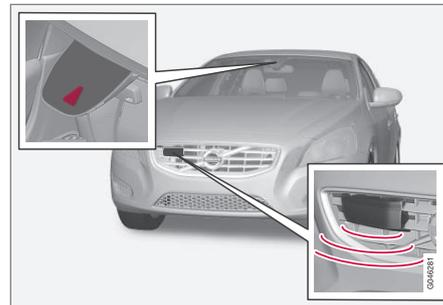
Sensor de cámara y de radar<sup>21</sup>.
