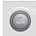
Gire el mando para aumentar o reducir la velocidad del ventilador. Si se selecciona **AUTO**, la velocidad del ventilador se regulará de forma automática (p. 141) y se desconectará la velocidad ajustada manual-
