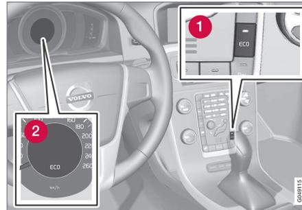
1 Conexión y desconexión de ECO
