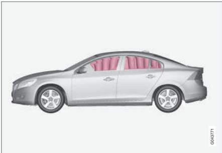
La cortina inflable IC (Inflatable Curtain) forma parte del sistema SIPS (p. 38) y el sistema de airbags (p. 33). Va montado a lo largo de ambos lados del techo interior y contribuye a proteger al conductor y a los pasajeros situados en los asientos exteriores del vehículo. En caso de una colisión de suficiente intensidad, los sensores reaccionan y el airbag de techo lateral se infla.
