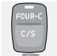
*Interruptores de la consola central de FOUR-C (excepto S60 R)*
