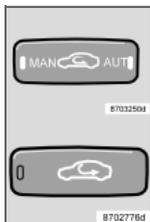
Il ricircolo si sceglie per impedire l'ingresso nell'automobile di cattivi odori, gas di scarico ecc. Quando è attivata questa funzione, l'aria all'interno dell'abitacolo viene sottoposta a ricircolo, cioè non viene prelevata aria dall'esterno.
