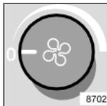
Gire el mando para aumentar o reducir la velocidad del ventilador. Si el mando está en 0, el aire acondicionado no se conecta.
