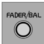
Ajuste convenientemente el balance de audio entre los altavoces delanteros y trasero pulsando la rueda y girándola a la derecha (más volumen en el par de altavoces delanteros) o a la izquierda (más volumen en el par de altavoces traseros). En la posición central, el balance está "normalizado". Una vez configurado,
