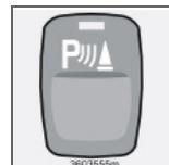
Este sistema está siempre conectado con el automóvil en funcionamiento. Pulse el botón de desconexión/reconexión del sistema de aparcamiento asistido. Véase también la pág. 128.
