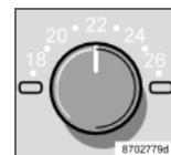
Utilizando los dos mandos, puede ajustar la temperatura de los lados del acompañante y del conductor. No olvide que el sistema no calentará ni enfriará el interior del vehículo con mayor rapidez aunque seleccione una temperatura superior o inferior a la que desea tener en el habitáculo.
