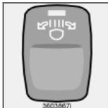
El haz luminoso de los faros ABL siguen los movimientos del volante al conducir. La función se conecta automáticamente al arrancar el automóvil y puede desconectarse/conectarse pul-
