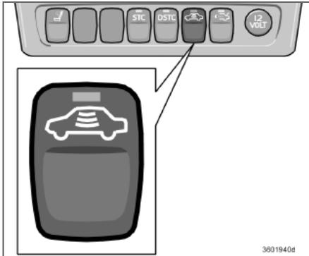
Para impedir que la alarma se accione de forma involuntaria como, por ejemplo, cuando se deja un perro solo en el vehículo o si el vehículo va en un transbordador, los sensores de inclinación y movimiento pueden desconectarse temporalmente:
