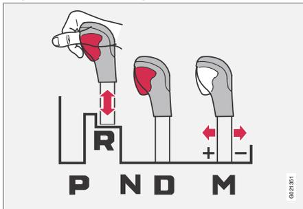
Рычаг можно свободно переводить вперед или назад между **N** и **D**. Остальные положения заблокированы и управляются кнопкой блокировки на селекторе передач.
