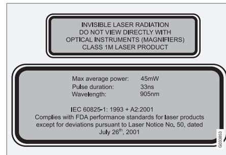
Верхняя табличка на рисунке определяет класс лазерного излучения:
