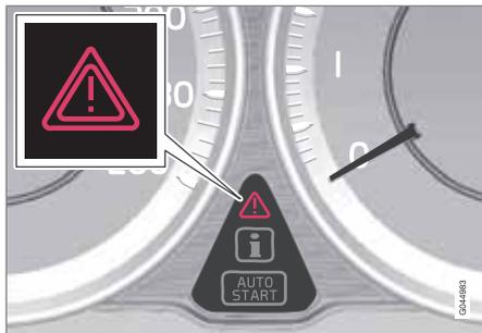
Если автомобиль участвовал в столкновении, на информационном дисплее может появиться текст **Аварийный режим См. руководство**. Это означает, что не все функции автомобиля выполняются в полном объеме. Режим безопасности это защита, которая задействуется, когда во время столкновения могли быть повреждены важные функции автомобиля, например, топливопроводы, датчики одной из систем защиты или система тормозов.
