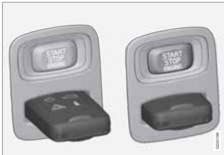
Замок запуска с выдвинутым/вставленным ключом зажигания.
