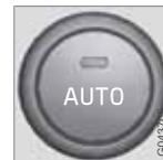
При помощи автофункции регулируется автоматически температура, кондиционирование воздуха, скорость вращения вентилятора, рециркуляция и распределение воздуха.
