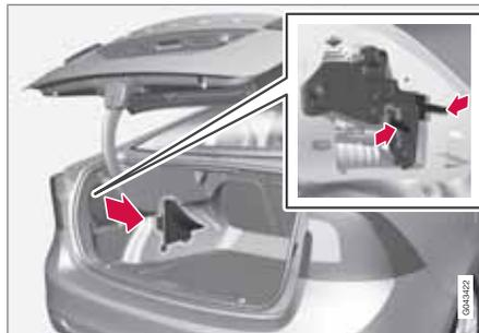
Лампы в задней комби-фаре заменяются изнутри багажного отделения (за исключением светодиодов).
