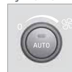
Для увеличения уменьшения скорости вентилятора поверните ручку. Если выбирается **AUTO**, скорость вентилятора устанавливается автоматически.
