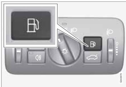
Откройте крышку топливного бака кнопкой на панели освещения – крышка откроется, когда вы опустите кнопку.
