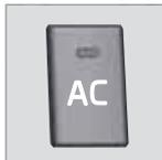
Когда в клавише **АС** горит лампа, кондиционирование воздуха работает в автоматическом режиме. В этом случае поступающий воздух охлаждается и подсушивается.
