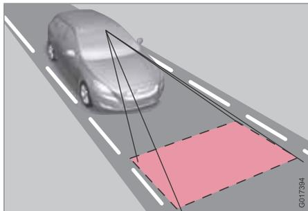
Функция предназначена для снижения риска т.н. одиночных аварий – аварий, которые происходят, когда автомобиль съезжает с полосы и может оказаться либо в кювете, либо на полосе встречного движения.
