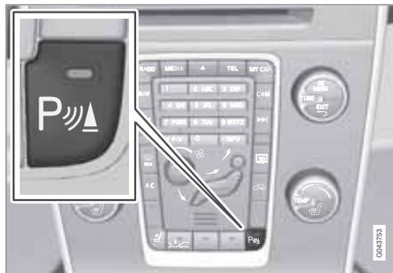
Система включается автоматически в момент запуска двигателя – горит лампа в выключателе Выкл/Вкл. Если помощь при парковке отключить кнопкой, лампа гаснет.
