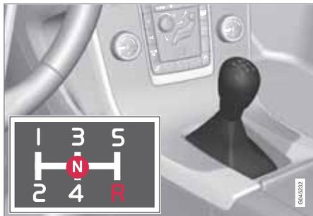
Схема переключения передач, 5-ступенчатая коробка передач.
