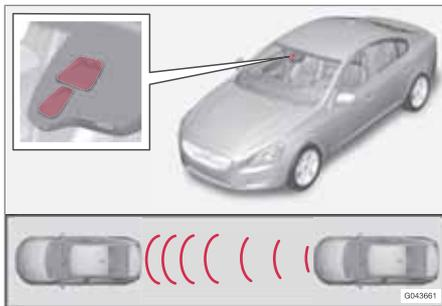
Приемно-выходное окно лазерного датчика<sup>1</sup>.
