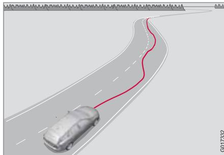
Функция предназначена для привлечения внимания водителя, когда автомобиль начинает двигаться зигзагообразно, например, если водитель отвлекается или засыпает.
