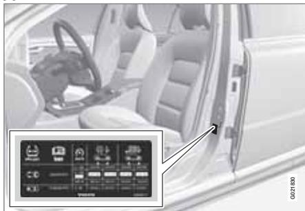
На наклейке, расположенной на дверной стойке со стороны водителя (между передней и задней дверью) указано давление в шинах при различной нагрузке и скоростях. Эта же информация приведена в таблице давления в шинах, см. стр. 398.
