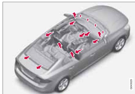
Поступающий воздух распределяется между различными соплами салона.
