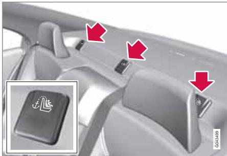
В автомобиле имеются верхние точки крепления детских кресел. Эти точки крепления расположены в полке для шляп и закрыты пластмассовыми крышками. Отогните вниз пластмассовые крышки, чтобы получить доступ к соответствующим точкам крепления.
