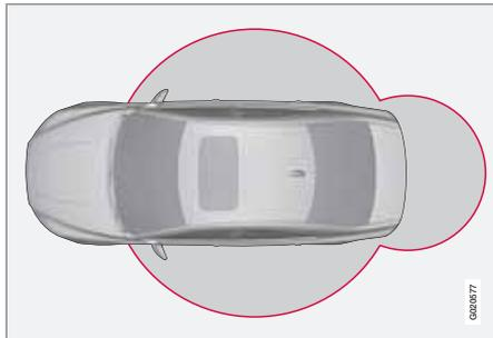
С помощью функции keyless drive в РСС автомобиль можно отпереть, управлять и запирать без использования ключа. Достаточно иметь с собой РСС. Используя эту систему, можно легко открыть автомобиль, например, когда у вас заняты руки.
