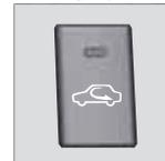
При включенной рециркуляции в клавише горит оранжевая лампа. Эта функция выбирается для прекращения доступа в салон плохого воздуха, выхлопных газов и пр. Воздух в салоне рециркулирует, т.е. если эта функция включена, воздух снаружи не поступает внутрь автомобиля.
