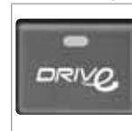
В некоторых ситуациях, если необходимо временно отключить автоматическую функцию Start/Stop, следует нажать на эту кнопку, и лампа в кнопке погаснет.
