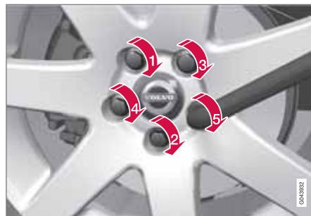
4. Затяните колесные болты крест-накрест. Важно, чтобы колесные болты были затянуты с нужной силой. Затягивайте с усилием 140 Нм. Проверьте момент затяжки динамометрическим ключом.
