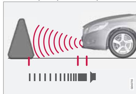
Расстояние, измеряемое по прямой перед автомобилем, составляет прим. 0,8 м. Звуковой сигнал, указывающий на препятствие перед автомобилем, поступает из одного из передних динамиков.
