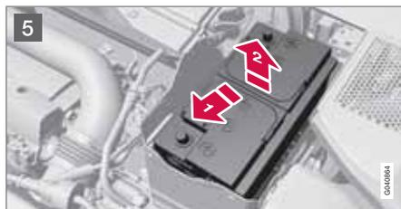
1 Откройте зажимы на передней защитной крышке и снимите крышку.
