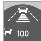
Вы можете выбрать различный временной интервал до автомобиля впереди вас, который отображается на дисплее в виде 1-5 горизонтальных штрихов – чем больше штрихов, тем
