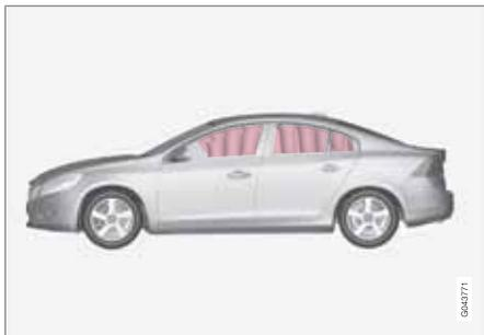
Надувной занавес IC (Inflatable Curtain) является составной частью SIPS и подушек безопасности. Он смонтирован в облицовке потолка вдоль боковин автомобиля и защищает пассажиров на внешних местах в автомобиле. При достаточно сильном столкновении датчики реагируют, и занавес надувается. Надувной занавес помогает во время столкновения защитить голову водителя и пассажиров от ударов о внутренние поверхности автомобиля.
