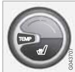
Ручкой вы можете устанавливать температуру. Для ECC\* температура на стороне водителя и пассажира может устанавливаться независимо.
