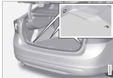
Откидные проушины для крепления груза<sup>1</sup> используются для фиксации стяжных лент, закрепляющих предметы в багажном отделении.
