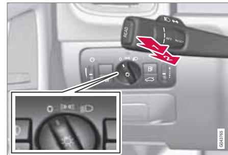
Ручка регулировки света и подрулевой рычаг.
