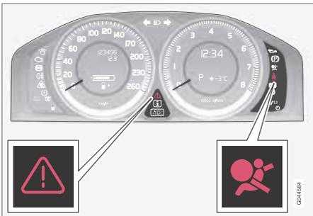
Предупреждающий символ в комбинированном приборе включается, когда дистанционный ключ находится в положении II или III. Этот символ гаснет прим. через 6 секунд, если система надувных подушек безопасности исправна.
