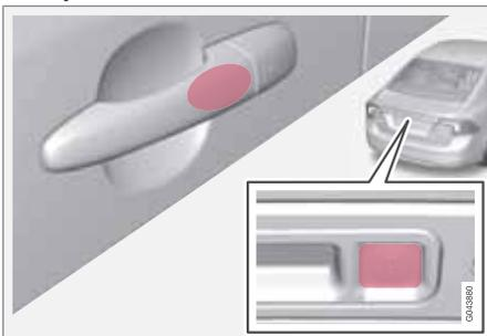
В автомобилях с системой без ключа Keyless имеется сенсорная зона на внешних дверных ручках, а также обрезиненная клавиша около обрезиненной нажимной пластины крышки багажника.
