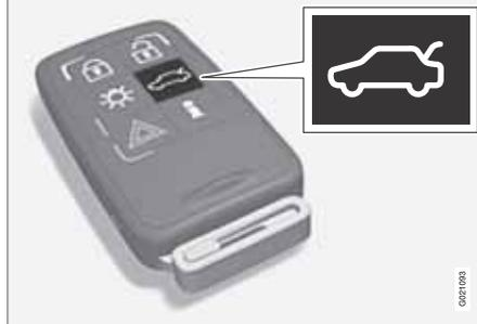
С помощью кнопки
