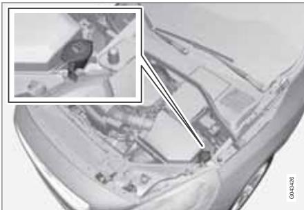
Омыватели ветрового стекла и фар имеют общий бачок с жидкостью.
