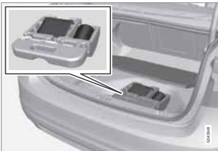
Временный шиноремонтный комплект (ТМК; Temporary Mobility Kit) используется для герметизации прокола, а также проверки и регулировки давления в шинах. Комплект состоит из компрессора и упаковки с жидким герметиком. и предназначен для проведения временного ремонта. Банка с жидким герметиком должна заменяться до истечения срока годности и после герметизации шины.
