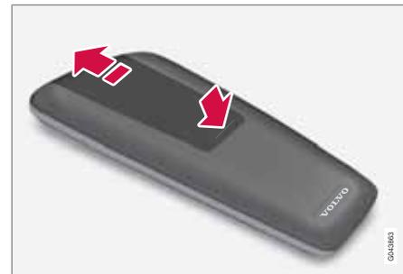
1. Нажмите фиксатор на крышке кармана для батареек и сместите крышку в направлении ИК-объектива.
