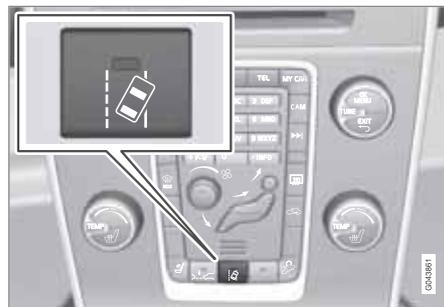
Функция включается или отключается переключателем на центральной консоли. Лампа в кнопке горит, когда функция включена.
