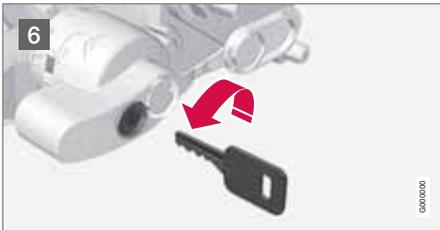
6 Поверните ключ против часовой стрелки в запертое положение. Выньте ключ из замка.
