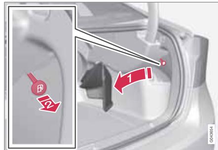
Крышку топливного бака можно открыть вручную, если электрический замок не срабатывает из салона.
