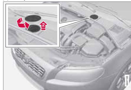
Расположение бачка с тормозной жидкостью.
