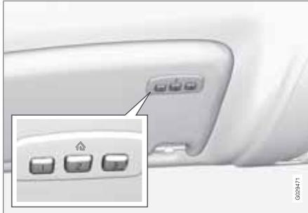
HomeLink® é um comando à distância programável que pode gerir até três dispositivos diferentes (por exemplo: porta da garagem, sistema de alarme, iluminação doméstica exterior ou interior, entre outros) e assim substituir todos os comandos à distância destes mesmos dispositivos. HomeLink® é entregue incorporado na protecção solar do lado esquerdo.
