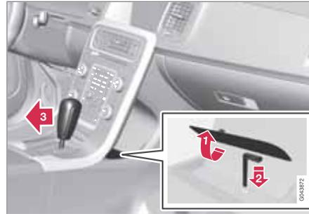
Se não for possível conduzir o automóvel, com a bateria de arranque descarregada, por exemplo, é necessário retirar a alavanca das mudanças da posição **P** para que seja possível deslocar o automóvel.
