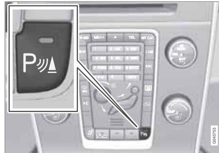
O sistema activa-se automaticamente com o arranque do motor - a lâmpada do interruptor Lig./Desl. acende. O sistema pode ser desligado com o botão, a lâmpada apaga.
