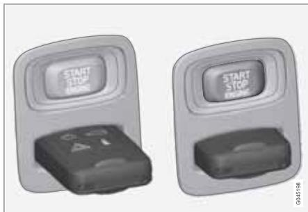
Fecho de ignição com o comando à distância ejectado/inserido.
