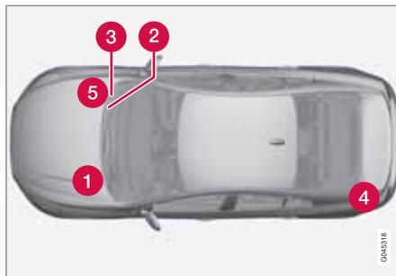
Localização das centrais eléctricas em modelos com volante à esquerda, no caso do automóvel ter volante à direita, as centrais mudam sob o lado do porta-luvas.
