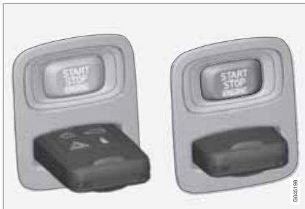
Fecho de ignição com comando à distância ejetado/inserido e botão **START/STOP ENGINE**.
