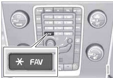
O botão **FAV** pode ser utilizado para guardar funções que são utilizadas com frequência, de forma a iniciar facilmente a função pressionando em **FAV**. Pode-se guardar um favorito (por exemplo **Equalizador**) para cada função de acordo com a lista seguinte:
