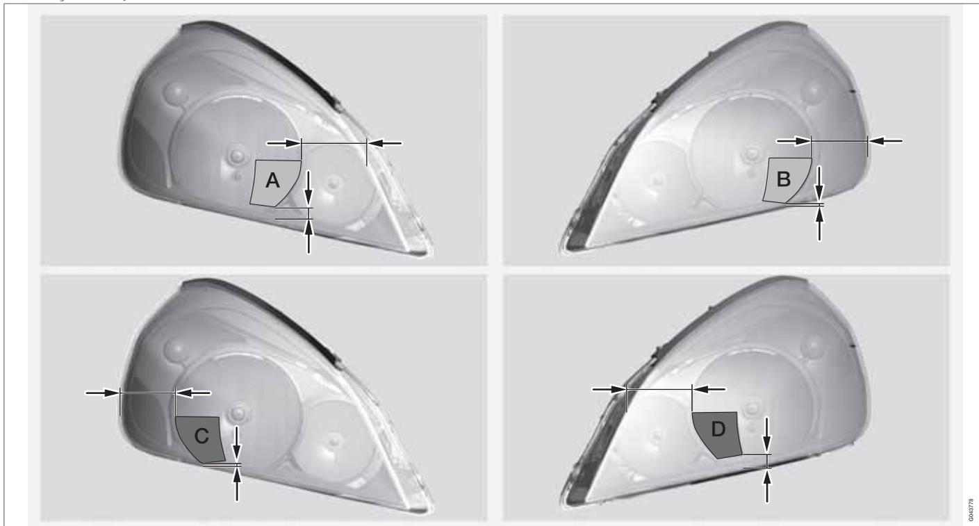
Linha superior: modelos com volante à esquerda, padrões A e B. Linha inferior: modelos com volante à direita, padrões C e D.
