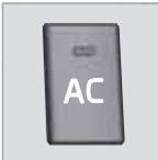
Quando a lâmpada no botão **AC** está acesa todo o ar condicionado do sistema é controlado automaticamente. Deste modo, o ar que entra é arrefecido e desumidificado.
