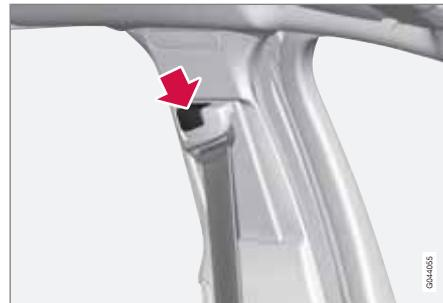
Ajuste em altura da ligação do cinto de segurança. Pressione o botão e desloque a ligação na vertical. Coloque a ligação o mais alto possível, sem que o cinto entre em contacto com o pescoço.
