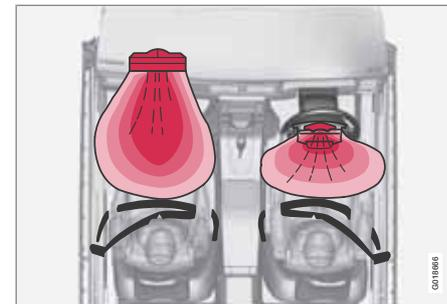
*O sistema dos airbags, modelos com volante à direita.*
