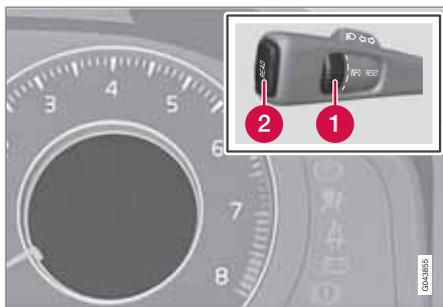
**1** Selector rotativo. Rode até o mostrador exibir **Driver Alert**. Na segunda linha podem aparecer as alternativas **Driver Alert Aguarda <65 km/h**, **Driver Alert Não disponível** ou a marcação de nível **[■ ■ ■ ]**.
