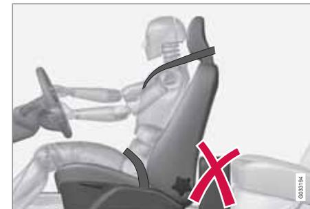
Não coloque qualquer objecto no piso atrás do banco do condutor/passageiro que possa evitar o funcionamento do sistema WHIPS.
