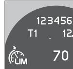
Quando o Limitador de velocidade está activo o mostrador exibe o seu símbolo juntamente com a velocidade máxima definida.
