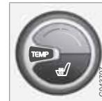
A temperatura pode ser ajustada com o botão selector. No ECC\* pode-se ajustar a temperatura do lado do condutor e do passageiro separadamente.
