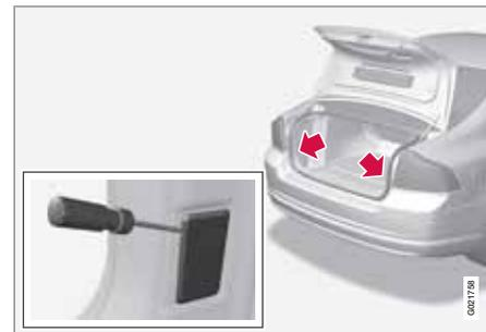
1. Introduza uma chave de fendas e force ligeiramente de modo a soltar o cárter das lâmpadas.
