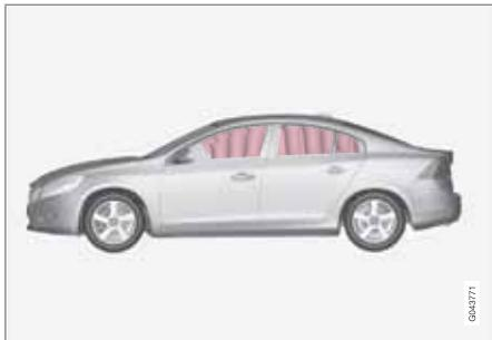
A cortina de colisão IC (Inflatable Curtain) é parte dos sistemas SIPS e dos airbags. Esta encontra-se montada ao longo do forro do tejadilho, em ambos os lados, e protege os ocupantes dos lugares laterais do automóvel. Perante uma colisão suficientemente forte, os sensores reagem e a cortina de colisão é insuflada. Durante uma colisão, a cortina de colisão ajuda a proteger o condutor e os passageiros de embates com a cabeça contra o interior do automóvel.
