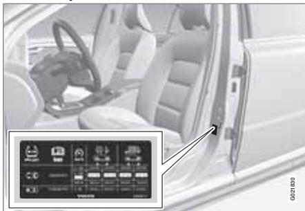
O autocolante da pressão dos pneus no pilar da porta do lado do condutor (entre a porta dianteira e traseira) indica as pressões corretas dos pneus para diferentes condições de carga e velocidades. Estas pressões também se encontram indicadas na tabela da pressão dos pneus, veja a página 385.
