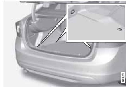
Os olhais de fixação de carga rebatíveis<sup>1</sup> são utilizados para prender as cintas de retenção que seguram a carga no compartimento da bagagem.
