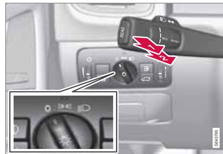
Mando de las luces y palanca del volante.
