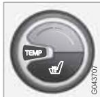
Con una pulsación del botón se obtiene el nivel de calefacción máximo. En la pantalla de la consola central se encienden tres luces de color naranja (véase la figura).
