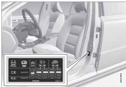
La placa de presión de neumáticos situada en el montante de la puerta del lado del conductor (entre la puerta delantera y la trasera) especifica la presión que deben tener los neumáticos en diferentes condiciones de carga y velocidad. Esos datos se indican asimismo en la tabla de presiones de neumáticos, ver la página 385.
