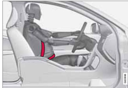
El cinturón de seguridad debe utilizarse siempre durante el embarazo, pero es importante que se emplee de manera correcta. El cinturón debe ir ajustado al hombro, con la banda diagonal entre los pechos y a un lado del estómago.
