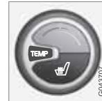
La temperatura puede ajustarse con el mando. En sistemas ECC\*, la temperatura puede ajustarse de manera independiente en el lado del conductor y el lado del acompañante.
