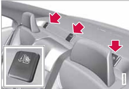
El automóvil está equipado con puntos de fijación superiores para asientos infantiles. Estos puntos de fijación están situados en la bandeja trasera y se ocultan con tapas de plástico. Aparte las tapas de plástico para acceder al punto de fijación respectivo.
