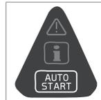
Para verificar y recordar que el motor se ha apagado automáticamente se enciende el símbolo **AUTO START** en la pantalla de información.
