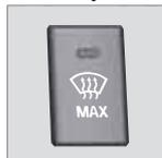
Se utiliza para eliminar rápidamente el vaho y el hielo de las parabrisas y las ventanillas laterales. El aire se envía hacia las ventanillas. Cuando la función está conectada, se enciende la luz del botón del desempañador.
