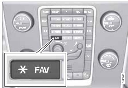
El botón **FAV** se utiliza para almacenar funciones que se emplean con frecuencia, lo que permite iniciar fácilmente la función pulsando **FAV**. Seleccione un favorito (por ejemplo **Ecuilizador**) para cada función de la siguiente manera:
