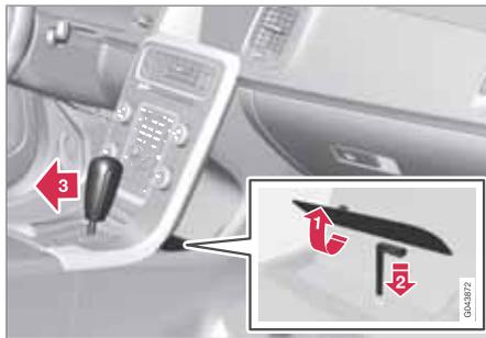
Si el automóvil no está en condiciones para conducirse, por ejemplo, si la batería de arranque está descargada, la palanca de cambios debe sacarse de la posición **P**, para poder mover el automóvil.
