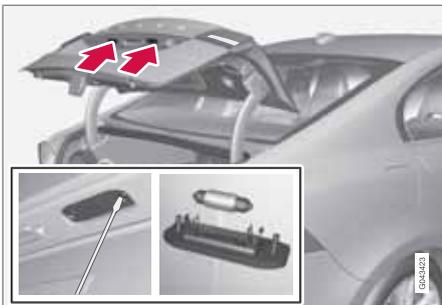
1. Suelte los tornillos con un destornillador.
