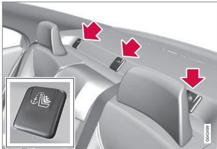
Em automóveis com encostos da cabeça rebatíveis nos lugares laterais deve-se rebater os encostos da cabeça para facilitar a montagem.
