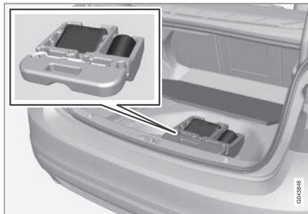
O kit de reparação de emergência de pneus furados encontra-se sob o chão do compartimento da bagagem.
