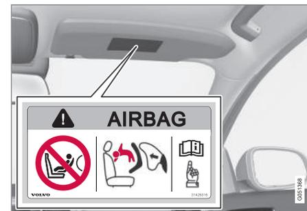
Alternativa 1: Localização do autocollante do airbag na protecção solar do lado do passageiro.
