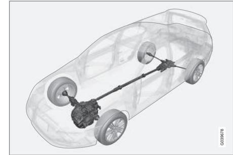
Tracção integral (All Wheel Drive) significa que todas as rodas do automóvel funcionam como motrizes em simultâneo.
