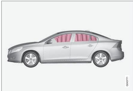
A cortina de colisão (Inflatable Curtain) faz parte do sistema SIPS (pág. 34) e do sistema de airbags (pág. 30). Esta encontra-se montada ao longo do forro do tejadilho, em ambos os lados, e protege os ocupantes dos lugares laterais do automóvel. Perante uma colisão suficientemente forte, os sensores reagem e a cortina de colisão é insuflada.
