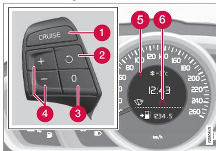
Teclado do volante e instrumento combinado no automóvel **sem** Limitador de velocidade<sup>4</sup>.
