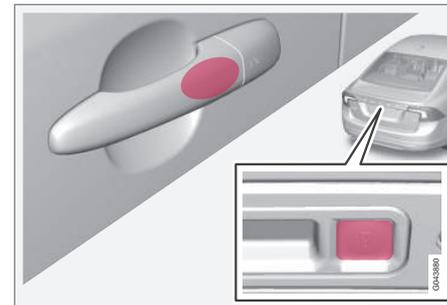
A zona de contacto nos puxadores exteriores das portas e um botão revestido a borracha na placa de pressão revestida a borracha no porta-bagagens.
