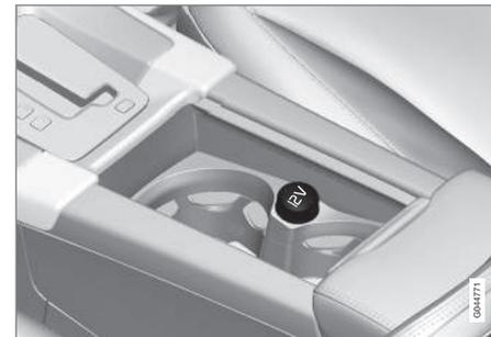
Tomada 12 V na consola de túnel, banco dianteiro.
