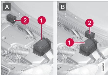
A: Modelos com volante à esquerda. B: Modelos com volante à direita. (1) Bateria de arranque<sup>19</sup>
