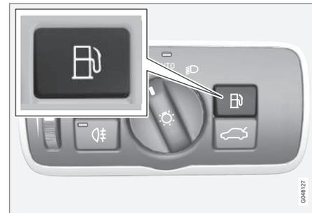
Le volet du réservoir de carburant est situé sur l'aile arrière droite (indiqué par une flèche à côté du symbole de réservoir de carburant dans la fenêtre de renseignement
