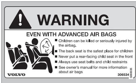
Autocollant indiquant le coussin gonflable sur la face extérieure des deux pare-soleil
