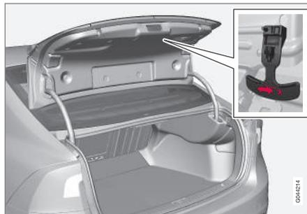
Le véhicule est équipé d'une poignée fluoescence sur la partie interne du couvercle du coffre; cette poignée permet d'ouvrir le coffre de l'intérieur en cas d'urgence. On doit abaisser la poignée pour débloquer le couvercle du coffre. Après utilisation, la poignée doit être repoussée en position initiale avant que le coffre puisse être refermé.
