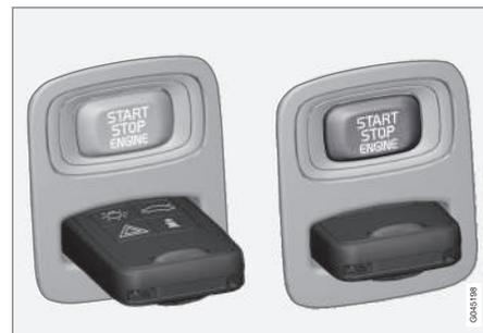
2. Insérer la clé-télécommande dans la fente d'allumage (également sur les véhicules équipés du démarrage sans clé en option). Cela arrêtera l'alarme.
