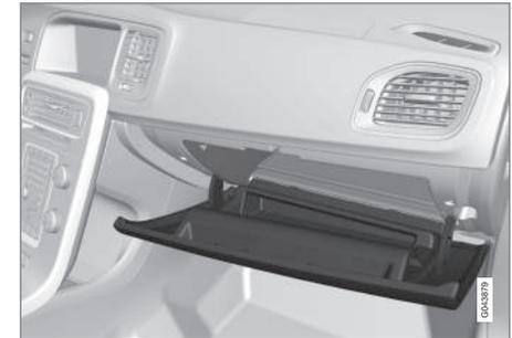
Vous pouvez ranger dans cet espace le manuel de l'utilisateur et les cartes. La boîte à gants contient également un porte-stylos et un porte-cartes de carburant. La boîte à gants peut être verrouillée manuellement à l'aide de la clé intégrée, voir page 78.
