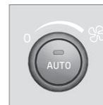
Tourner la commande dans le sens horaire pour augmenter la vitesse du ventilateur et dans le sens antihoraire pour la diminuer. Si la commande **AUTO** est sélectionnée, la vitesse du ventilateur sera contrôlée automatiquement et cela neutralisera le réglage manuel.
