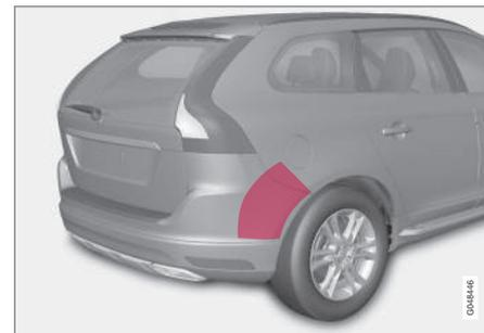
Emplacement des capteurs BLIS/CTA<sup>2</sup>
