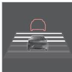
On peut choisir des intervalles de temps différents qui apparaîtront au tableau de bord<sup>2</sup> sous forme de 1 à 5 barres horizontales. Plus le nombre de barres est élevé, plus l'intervalle de temps est
