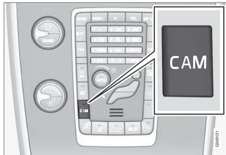
La PAC est activée lorsqu'on déplace le levier de vitesses à **R** si le système est sélectionné dans le système de menu **MY CAR** ou si on appuie sur le bouton **CAM** dans la console centrale. Voir la page 235 pour une description du système de menu.
