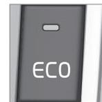
Lorsque ECO est désactivé, le symbole **ECO** n'est **pas** affiché au tableau de bord et la lampe indicatrice du bouton **ECO est éteinte**. La fonction reste désactivée jusqu'à la pression suivante sur le bouton.
