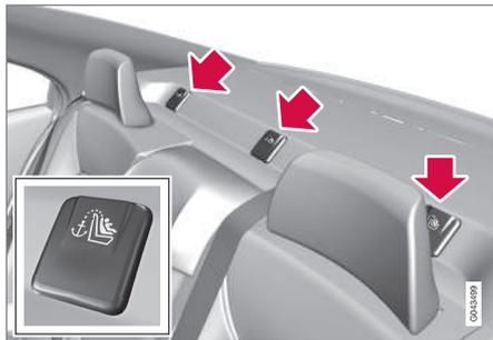
La banquette arrière de votre Volvo est munie d'ancrages d'attache supérieurs pour système de retenue pour enfant. Ils sont situés sur la plage arrière.
