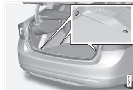
Les œillets d'ancrage situés des deux côtés du véhicule servent à fixer des courroies et autres pour retenir des objets dans le coffre.
