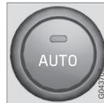
Cette fonction règle automatiquement le refroidissement, le chauffage, la vitesse du ventilateur, la recirculation et la circulation d'air de manière à maintenir la température choisie. Si vous sélectionnez une ou plusieurs fonctions manuelles, les autres fonctions continuent d'être commandées automatiquement. Le capteur de qualité de l'air est activé et tous les réglages manuels sont éteints lorsqu'on appuie sur **AUTO**. Le message **CLIM AUTOMATIQUE** apparaît dans l'affichage.
