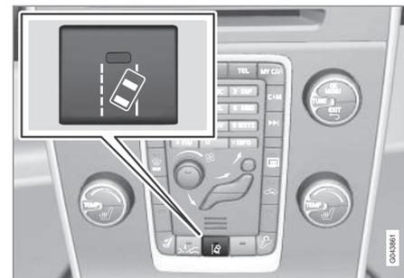
On peut activer ou désactiver le LDW en appuyant sur le bouton de la console centrale. Un témoin dans le bouton s'allume lorsque le système est activé. Ceci est com-
