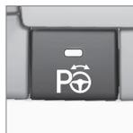
1. Activer le système PAP en appuyant sur le bouton de la console centrale et au besoin, ralentir jusqu'à une vitesse inférieure à 20 mph (30 km/h).
