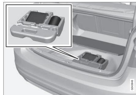
Il kit di riparazione pneumatici è collocato sotto il pavimento del bagagliaio.
