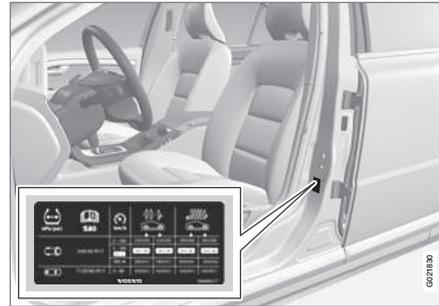
L'etichetta pressione pneumatici sul montante della portiera del conducente (tra portiera anteriore e posteriore) indica le pressioni dei pneumatici richieste in base al carico e alla velocità. Queste sono riportate anche nella tabella delle pressioni pneumatici, vedere Pneumatici - pressioni dei pneumatici approvate (p. 454).
