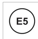
E5 è una benzina contenente max il 2,7% di ossigeno e max il 5% in volume di etanolo.
