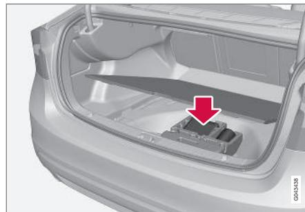
Sotto il pianale di carico sono riposti l'occhio di traino, il martinetto\* e la chiave per le colonnette\*. Qui c'è anche spazio per la chiave delle colonnette bloccabili e l'attrezzo per i cappucci di plastica delle colonnette.
