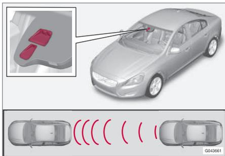
Finestre di trasmissione e ricezione del sensore laser<sup>13</sup>.
