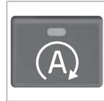
La funzione Start/Stop si attiva automaticamente all'accensione del motore con la chiave. Il conducente è avvertito di ciò mediante l'accensione della spia della funzione nel quadro strumenti e della spia del pulsante On/Off.
