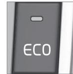
Se la funzione ECO è attivata, il motore potrebbe spegnersi automaticamente prima che l'automobile si fermi.
