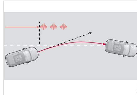
Avvertimento con vibrazioni nel volante<sup>30</sup>.
