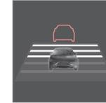
È possibile selezionare diverse distanze temporali dal veicolo antistante, che vengono visualizzate sul quadro strumenti con 1-5 linee orizzontali; più linee sono visualizzate maggiore è la distanza temporale. 1 linea corrisponde a circa 1 secondo, 5 linee a
