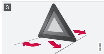
Il triangolo di emergenza è collocato nel baule e fissato con due fermagli.
