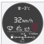
Con il quadro strumenti "Analog" sono visualizzati al centro di esso le posizioni del cambio e le frecce indicatrici.
