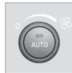
Ruotare la manopola per aumentare o ridurre la velocità della ventola. Se si seleziona **AUTO**, la velocità della ventola si regola automaticamente (p. 137) - la velocità della ventola precedentemente impostata viene disinserita.
