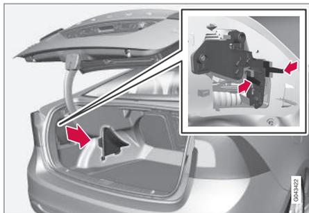
Le lampadine del gruppo luci posteriore si sostituiscono dall'interno del bagagliaio (escl. lampadine LED).
