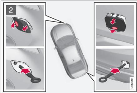
Rimozione delle coperture anteriore e posteriore.
