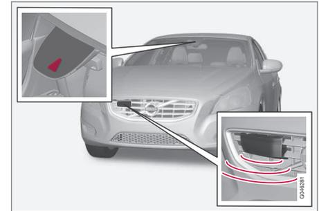
Sensore telecamera e radar<sup>21</sup>.
