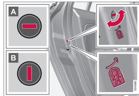
Fermo di sicurezza per bambini manuale. Da non confondere con il Bloccaggio manuale della portiera (p. 179).
