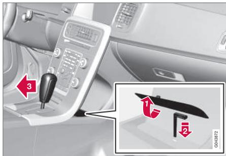
Se non è possibile guidare l'automobile, ad esempio perché la batteria di avviamento è scarica, occorre uscire dalla posizione **P** della leva selettoria per spostare l'automobile.
