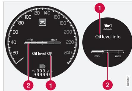
Messaggio e grafica visualizzati sul display. Il display sinistro è visualizzato nel quadro strumenti digitale e quello destro nel quadro strumenti analogico.
