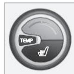
Il pomello consente di impostare la temperatura separatamente per i lati conducente e passeggero.
