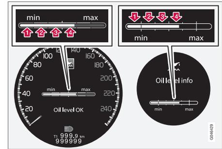
I numeri 1-4 indicano il livello di riempimento. Non rabboccare olio se è visualizzato il livello di riempimento (3) o (4). Il livello di riempimento raccomandato è 4.
