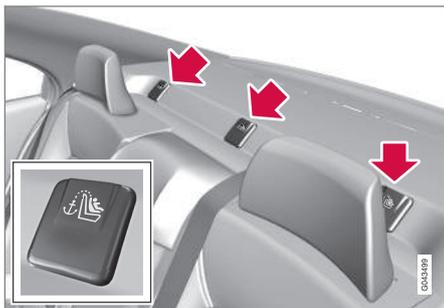
Per le automobili dotate di poggiatesta ripiegabili sui posti esterni, i poggiatesta devono essere ripiegati per facilitare il montaggio.
