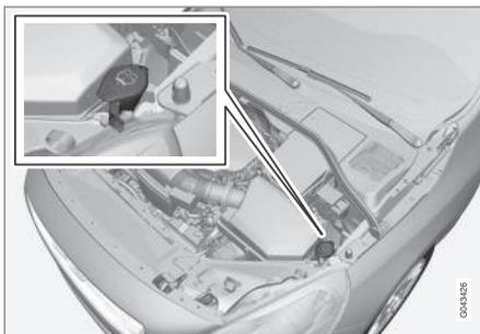
Il riempimento del liquido lavavetri avviene mediante l'apertura del tappo blu.
