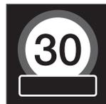
Un simbolo per l'insegna supplementare sotto forma di un riquadro vuoto sotto il segnale di velocità del quadro strumenti<sup>26</sup>, sta ad indicare che RSI ha rilevato un cartello aggiuntivo con informazioni di completamento per il limite di velocità in questione.
