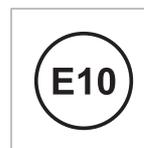
E10 è una benzina contenente max il 3,7% di ossigeno e max il 10% in volume di etanolo.
