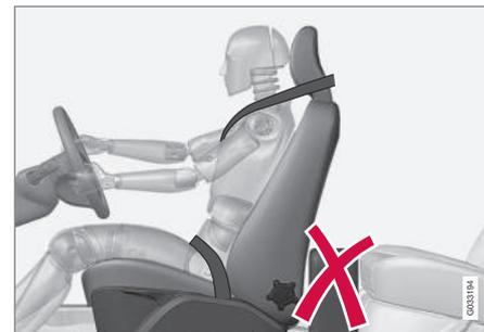
Non sistemare sul pavimento dietro il sedile di conducente/passeggero alcun oggetto che possa compromettere la funzionalità del sistema WHIPS.
