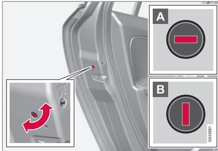
Bloccaggio manuale della portiera. Da non confondere con il fermo di sicurezza per bambini (p. 184).
