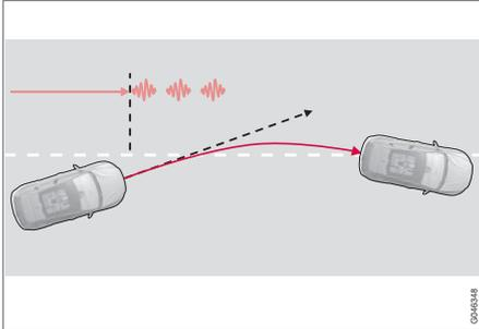
La funzione LKA sterza e avverte il conducente mediante vibrazioni nel volante<sup>32</sup>.
