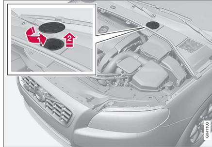
Il serbatoio dell'olio è collocato sul lato conducente.
