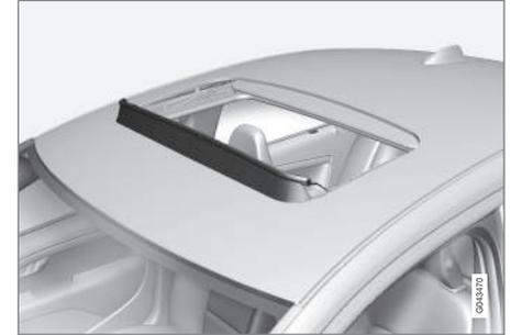
Le toit ouvrant est doté d'un déflecteur qui se déploie lorsque le toit ouvrant est ouvert.
