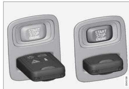
Contacteur d'allumage avec télécommande retirée/insérée.
