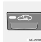
Рециркуляция используется для защиты салона от проникновения снаружи загрязненного воздуха, выхлопных газов и т.п. Воздуха циркулирует внутри салона. Снаружи воздух в автомобиль не затягивается. При помощи рециркуляции (вместе с системой кондиционирования) салон охлаждается быстрее в жаркую погоду. При длительной рециркуляции возможно запотевание окон изнутри.
