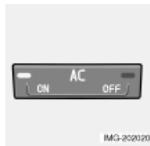
Когда светится светодиод ON, система кондиционирования находится в автоматическом режиме управления. В этом режиме
