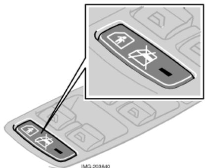
*Блокирование задних электрических стеклоподъемников или замок для безопасности детей<sup>1</sup>*
