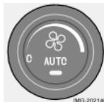
В режиме AUTO система управления микроклиматом автоматически поддерживает заданную температуру. Осуществляется автоматическое управление обогревом, кондиционированием, скоростью вентилятора, рециркуляцией и распределением воздуха. При ручном выборе одной или нескольких функций управление остальными функциями продолжает осуществляться в автоматическом режиме. Нажав на клавишу AUTO, Вы отменяете все настройки,
