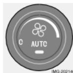
La fonction AUTO permet de régler automatiquement la climatisation afin d'atteindre la température souhaitée. Cette fonction contrôle le chauffage, la climatisation, la ventilation, la recirculation et la distribution de l'air. Lorsque vous sélectionnez une ou plusieurs fonctions manuelles, les autres fonctions continuent à être contrôlées automatiquement. Lorsque vous appuyez sur AUTO, tous les réglages manuels sont annulés. L'écran affiche CLIMATE AUTO.
