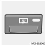
Ce bouton est utilisé pour dégivrer et désembuer rapidement la lunette arrière et les rétroviseurs extérieurs.
