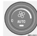
En tournant le bouton, la vitesse du ventilateur augmente ou diminue. La vitesse du ventilateur est réglée automatiquement si AUTO est sélectionné. La vitesse de ventilation précédemment définie est alors annulée.
