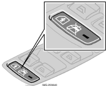
*Neutralisation des lève-vitres électriques arrière et verrouillage de sécurité enfant électrique<sup>1</sup>*
