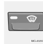
Cette fonction permet de désembuer rapidement le pare-brise et les vitres latérales. Le flux d'air est dirigé sur les vitres grâce à la vitesse élevée du ventilateur.
