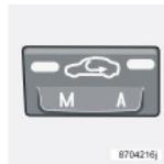
Cette fonction permet d'isoler l'habitacle de l'air vicié extérieur, des gaz d'échappement, etc. L'air de l'habitacle est recyclé. L'air extérieur ne pénètre pas
