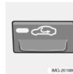
Vous pouvez choisir la recirculation d'air pour isoler l'habitacle de l'air vicié extérieur, des gaz d'échappement, etc. L'air de l'habitacle est recyclé. L'air extérieur ne pénètre pas dans la voiture lorsque cette fonction est activée. Grâce à la recirculation (et au système de climatisation), l'habitacle est refroidi plus rapidement par temps chaud. Si l'air circule trop longtemps dans la voiture, de la buée peut se former sur l'intérieur des vitres.
