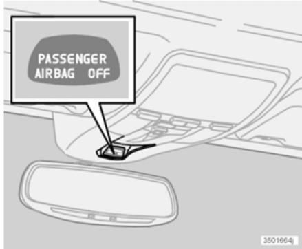
Indicación que muestra que el airbag (SRS) del acompañante está desactivado.
