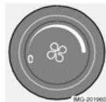
Aumente o reduzca la velocidad del ventilador girando el mando. Si gira el mando hacia la izquierda y desaparece de la pantalla la indicación del ventilador, se desconectan el ventilador y el aire acondicionado. En la pantalla aparece el símbolo del ventilador y las letras OFF.
