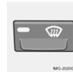
Se utiliza para quitar rápidamente el vaho y el hielo del parabrisas y de las ventanillas. El aire sale hacia las ventanillas a alta velocidad del ventilador. Cuando está
