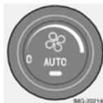
La función AUTO regula automáticamente el climatizador para obtener la temperatura seleccionada. La función automática regula el aire acondicionado, la velocidad del ventilador, la recirculación y la distribución del aire. Si se seleccionan una o más funciones manuales, las demás funciones seguirán operando de forma automática. Cuando se pulsa el botón AUTO, se desactivan todos los ajustes manuales. En la pantalla aparece el texto CLIMAT AUTOM.
