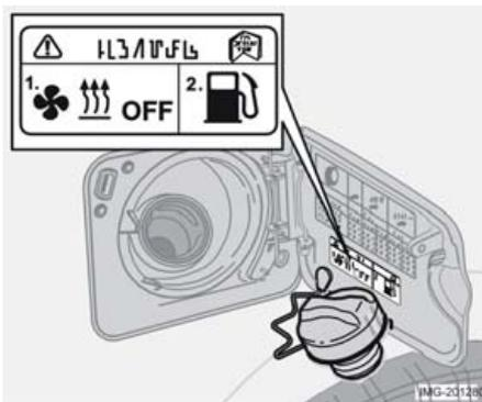
*Desconecte el calefactor accionado por combustible antes de repostar.*
