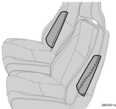
Colocación de airbag laterales.
