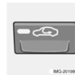
La recirculación se selecciona para impedir la entrada en el habitáculo de aire contaminado, gases de escape, etc. Cuando está activada esta función, el aire del habitáculo recircula y no entra en el vehículo aire del exterior. Si se selecciona la recirculación (junto con el equipo de aire acondicionado), el habitáculo tarda menos en enfriarse en climas cálidos. Si el aire recircula demasiado tiempo en el interior del vehículo, puede formarse vaho en la parte interior de los cristales.
