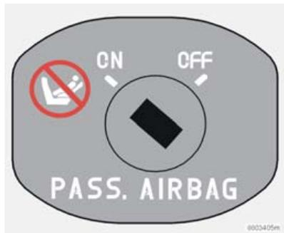
*Conmutador para SRS en posición ON.*
