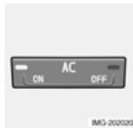
Cuando se enciende el diodo ON, el sistema regula el aire acondicionado de forma automática. De esta manera, el aire que entra se enfría y se deshumedece lo suficiente. Cuando se activa el diodo OFF, el aire acondicionado está siempre desconectado. Las demás funciones siguen regulándose automáticamente. Si se selecciona el desempañador (4), el aire acondicionado se regula automáticamente para deshumedecer el aire al máximo.
