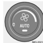
Gire el mando para aumentar o reducir la velocidad del ventilador. Si se selecciona AUTO, la velocidad del ventilador se regula de forma automática.
