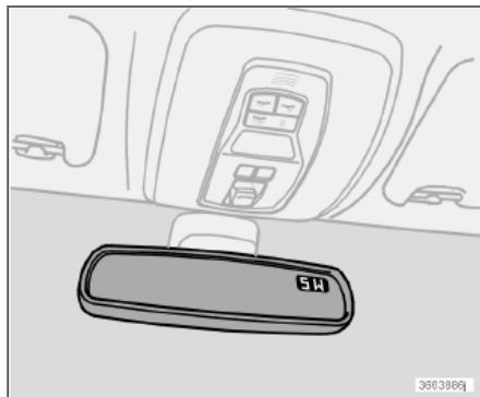
В верхнем правом углу зеркала заднего вида находится дисплей компаса для отображения направления движения автомобиля. На нем могут отображаться восемь различных направлений, обозначенных английскими сокращениями: **N** (Север), **NE** (Северо-восток), **E** (Восток), **SE** (Юго-восток), **S** (Юг), **SW** (Юго-запад), **W** (Запад) и **NW** (Северо-запад).
