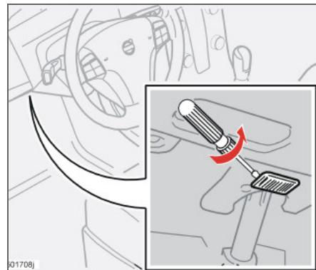
Освещение порогов расположено под приборной панелью на стороне водителя и пассажира.
