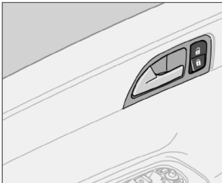
Кнопкой блокировки на дверной ручке можно одновременно запирать и отпирать все двери и крышку багажника.
