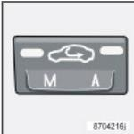
Данная функция выбирается для защиты салона от проникновения несвежего воздуха, выхлопных газов и т.п. Пока задействована эта функция, воздух
