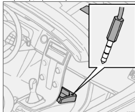
Вывод для внешнего источника звучания (AUX) 3,5 мм
