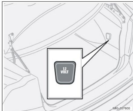
Для доступа к электрическому гнезду нужно откинуть крышку. Напряжение на гнездо подается независимо от положения замка зажигания. Если при выключенном зажигании к гнезду подключен потребитель, потребляющий силу тока более 0,1 А, на информационном дисплее отображается предупреждение. Не пользуйтесь этим электрическим гнездом при выключенном зажигании. Это может разрядить аккумуляторную батарею.
