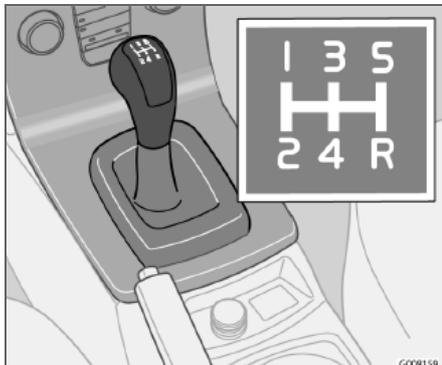
Полностью выжимайте педаль сцепления при каждом переключении передачи. Снимайте ногу с педали сцепления между переключениями передач! Следуйте указанной схеме переключения передач.
