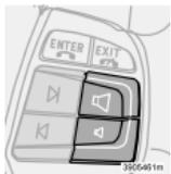
Громкость разговора регулируется при помощи кнопок на рулевом колесе.
