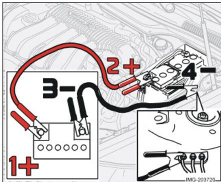
Если аккумуляторная батарея разрядилась, то для пуска двигателя можно "позаимствовать" электроэнергию от отдельного аккумулятора или аккумулятора другого автомобиля. Во избежание искрообразования при попытке пуска двигателя обязательно проверьте надежность крепления зажимов на пусковых проводах.
