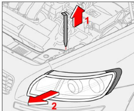
Все лампы впереди (за исключение противотуманных) можно заменить из двигательного отсека, отсоединив и вынув всю фару в сборе.
