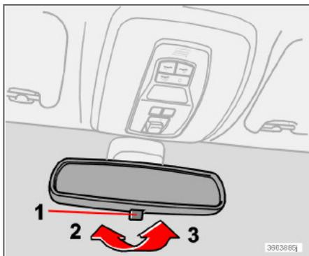
Эта иллюстрация получена монтажом. Зеркало заднего вида имеет либо ручную, либо автоматическую функцию противоослепления.
