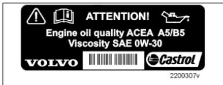
Если приведенная рядом табличка с характеристиками масла установлена в двигательном отсеке Вашего автомобиля, имеет место следующее. Размещение см. стр. 228.
