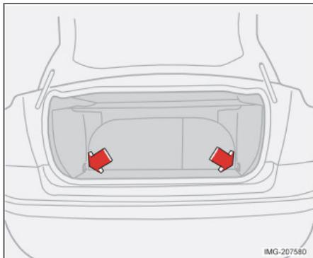
Крепежные проушины служат для крепления багажных ремней или сеток, предназначенных для фиксации груза в багажнике.
