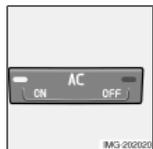
**ON:** Кондиционирование воздуха включено. Регулируется системой автоматически. В этом случае поступающий воздух охлаждается и подсушивается.
