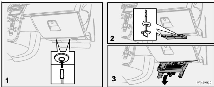
В блоке находятся 50 гнезд предохранителей. Предохранители расположены под перчаточным ящиком. Здесь же имеется несколько гнезд для резервных предохранителей. Инструмент для замены предохранителей находится в блоке реле/предохранителей в двигательном отсеке, см. с. 195.
