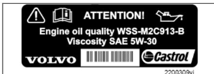
Если приведенная рядом табличка с характеристиками масла установлена в двигательном отсеке Вашего автомобиля, имеет место следующее. Размещение см. стр. 228.
