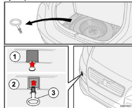
Для буксировки по дороге используйте буксировочную проушину. Буксировочная проушина крепится в проеме с правой стороны переднего или заднего бампера.
