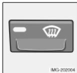
Для быстрого удаления запотевания и обледенения с ветрового и боковых стекол. Поток воздуха направляется на стекла при высокой скорости вентилятора.
