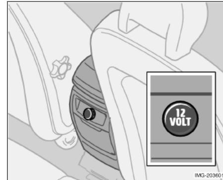
Электрическое гнездо можно использовать для различных электроприборов, например, мобильного телефона или холодильника. Оно рассчитано на 12 В. Максимальная сила тока 10 А. Напряжение на гнездо подается, если ключ зажигания находится, как минимум в положении **I**.
