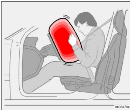
В дополнение к ремню безопасности автомобиль оснащен надувной подушкой безопасности SRS (Supplemental Restraint System) в рулевом колесе. Надувная подушка безопасности сложена в центральной части рулевого колеса. Такое рулевое колесо имеет маркировку **SRS AIRBAG**.
