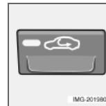
Рециркуляция используется для защиты салона от проникновения снаружи загрязненного воздуха, выхлопных газов и т.п. Воздуха циркулирует внутри салона. Снаружи
