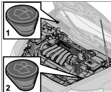
Местоположение бачка омывающей жидкости<sup>1</sup>.
