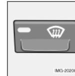
Для быстрого удаления запотевания и обледенения с ветрового и боковых стекол. Поток воздуха направляется на стекла при высокой скорости вентилятора.
