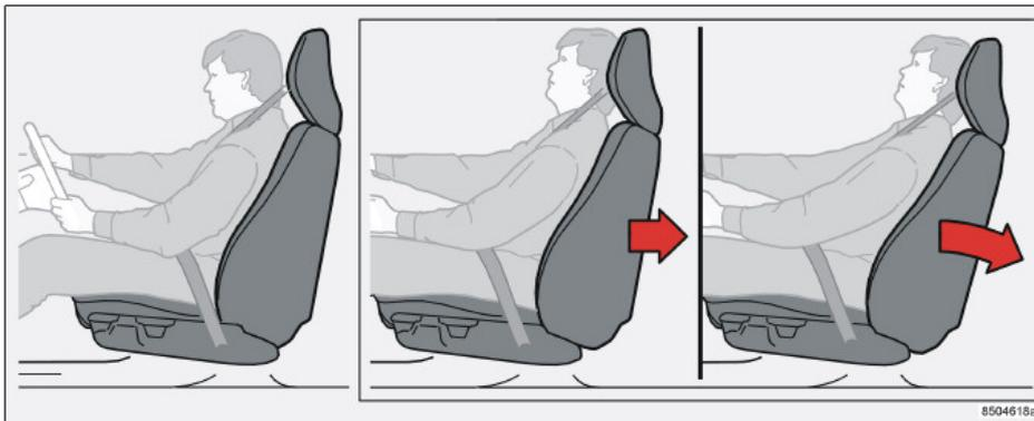
Система WHIPS (Whiplash Protection System) состоит из энергопоглощающей спинки и специально модернизированного для данной системы подголовника в передних сиденьях. Система активируется в момент удара сзади, и ее срабатывание зависит от угла удара, скорости и вида транспортного средства, нанесшего удар.
