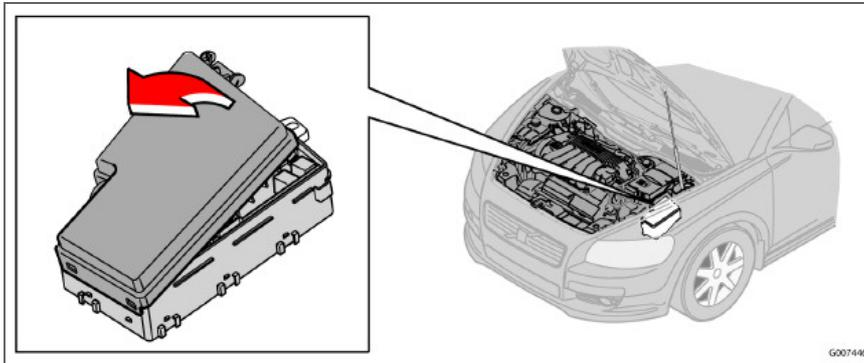
В этом блоке находятся 36 гнезд предохранителей. При замене перегоревшего предохранителя убедитесь, что новый предохранитель имеет такие же цвет и ампераж.
