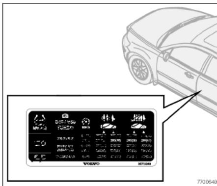
На наклейке, расположенной на дверной стойке на стороне водителя, указано давление в шинах при различной нагрузке и скоростях.
