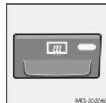
Ce bouton est utilisé pour dégivrer et désembuer rapidement la lunette arrière et les rétroviseurs extérieurs.
