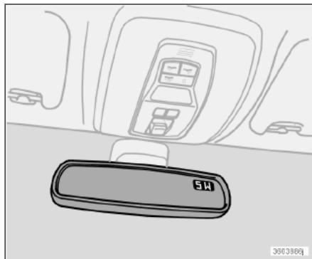
Un écran est intégré dans l'angle supérieur droit du rétroviseur intérieur qui indique la direction de conduite (avant de la voiture). Huit illustrations différentes sont présentées avec des abréviations en anglais : N (Nord), NE (Nord-est), E (Est), SE (Sud-est), S (Sud), SW (Sud-ouest), W (Ouest) et NW (Nord-ouest).
