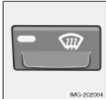
Pour dégivrer et désembuer rapidement le pare-brise avant et les vitres latérales. De l'air est envoyé à grande vitesse de ventilation sur les vitres. Le témoin du bouton de dégivrage s'allume lorsque cette fonction est activée.
