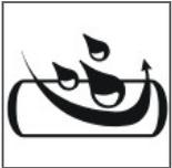
Les rétroviseurs munis de ce traitement hydrofuge et antipoussière sont marqués d'un petit symbole. Pour de plus amples informations sur l'entretien des rétroviseurs, voir page 169.
