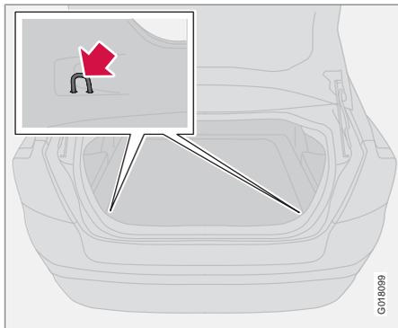
Les œillets de retenue de charge permettent de fixer des sangles ou un filet pour maintenir les objets en place dans le compartiment à bagages.
