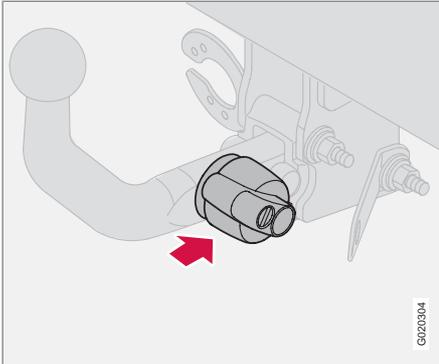
4. Insérez et faites coulisser la boule jusqu'à ce qu'un déclic se fasse entendre.
