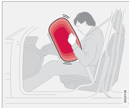
En complément des ceintures de sécurité du côté conducteur, la voiture est équipée d'un coussin gonflable SRS (Supplemental Restraint System - système de retenue supplémentaire). Le coussin gonflable est plié au centre du volant. Le volant porte l'inscription **SRS AIRBAG**.
