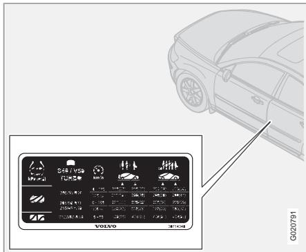
L'autocollant de pressions de pneu sur le montant de porte du côté conducteur quelle pression les pneus doivent avoir à différentes conditions de charge et de vitesse.
