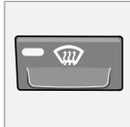
Pour dégivrer et débarrasser rapidement le pare-brise avant et les vitres latérales. Dirigez le flux d'air sur les vitres en utilisant une vitesse de ventilation élevée. La diode du bouton de dégivrage
