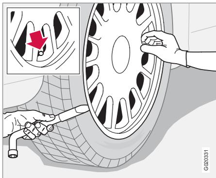
Placez le triangle de présignalisation si une roue doit être changée dans un endroit exposé à la circulation. Veillez à ce que la voiture et le cric soient sur un sol horizontal et plan.
