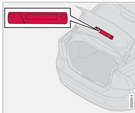
*Le triangle de signalisation est fixé à l'intérieur du coffre à bagages avec deux clips.*
