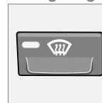
Pour dégivrer et désembuer rapidement le pare-brise avant et les vitres latérales. Dirigez le flux d'air sur les vitres en utilisant une vitesse de ventilation élevée. La diode du bouton de dégivrage s'allume lorsque la fonction est connectée.
