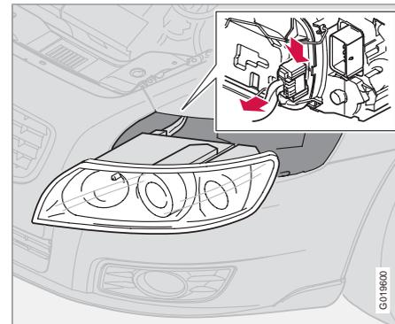
5. Sortez le bloc optique par le haut et placez-le sur une surface douce de façon à ne pas rayer la lentille.
