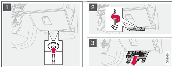
Le boîtier de fusibles contient 50 emplacements de fusible. Les fusibles sont situés sous la boîte à gants. Il existe aussi des emplacements pour les fusibles de recharge. Des outils pour le remplacement des fusibles se trouvent dans le boîtier du compartiment moteur, voir page 223.
