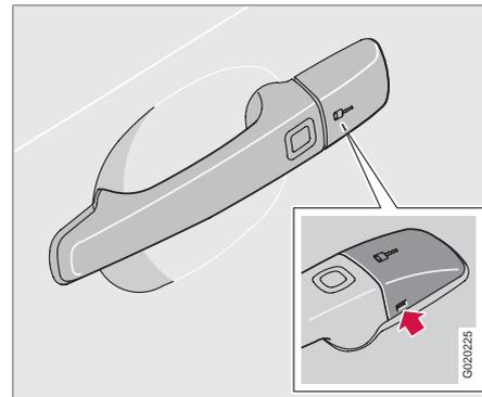
Si le verrouillage centralisé ne peut pas être activé avec la télécommande, si les piles sont déchargées par exemple, il est possible d'ouvrir la porte conducteur de la manière suivante :
