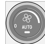
Tournez la molette pour augmenter ou réduire la vitesse du ventilateur. Si **AUTO** est sélectionné, la vitesse du ventilateur est régulée automatiquement. Le précédent réglage de la vitesse de ventilateur est supprimé.
