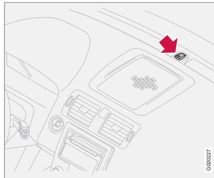
Une diode rouge sur le tableau de bord indique l'état du système d'alarme :
