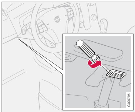
L'éclairage d'embarquement se trouve sous le tableau de bord des côtés conducteur et passager.
