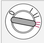
Le démarreur est actionné. Relâchez la clé dès que le moteur a démarré. La clé de contact se replace automatiquement en position de conduite.
