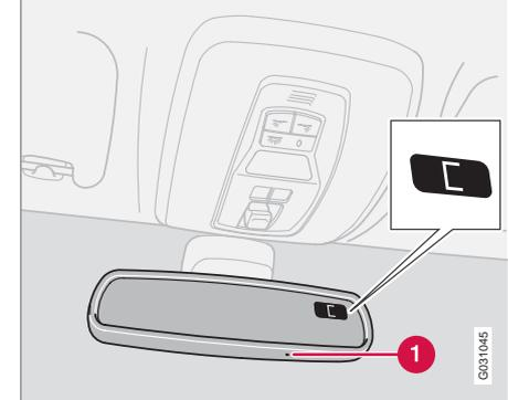
La terre est divisée en 15 zones magnétiques. La boussole est réglée pour la zone géographique dans laquelle la voiture a été livrée. La boussole doit être recalibrée si la voiture change de zone magnétique.
