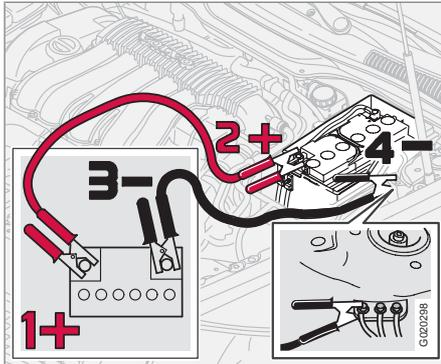
Si la batterie de la voiture est déchargée, il est possible de se servir d'une batterie auxiliaire ou de la batterie d'un autre véhicule. Veillez toujours à ce que les pinces du câble de démarrage soient bien serrées pour éviter la production d'étincelles lors d'une tentative de démarrage.
