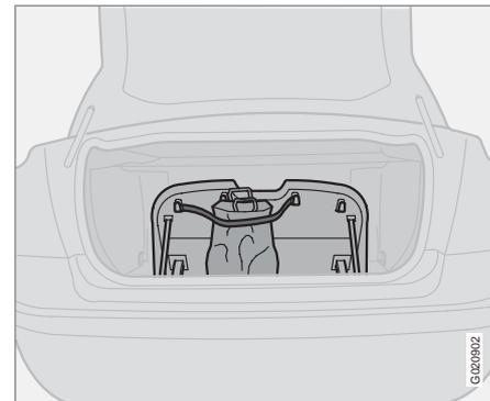
Le crochet pour sac à provision permet de maintenir les sacs en place et évite que le contenu ne se déverse dans le compartiment à bagages.
