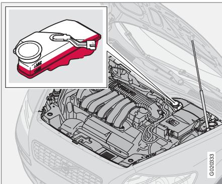
Les liquides de frein et d'embrayage ont le même réservoir <sup>2</sup>. Le niveau doit se trouver entre les repères **MIN** et **MAX** de la jauge. Vérifiez le niveau régulièrement. Remplacez le
