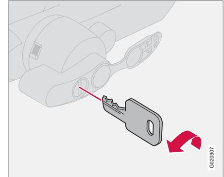
6. Tournez la clé dans le sens inverse des aiguilles d'une montre jusqu'en position de verrouillage. Retirez la clé de la serrure.
