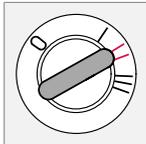
C'est la position de la clé de contact en conduite. Le système électrique de la voiture est activé.
