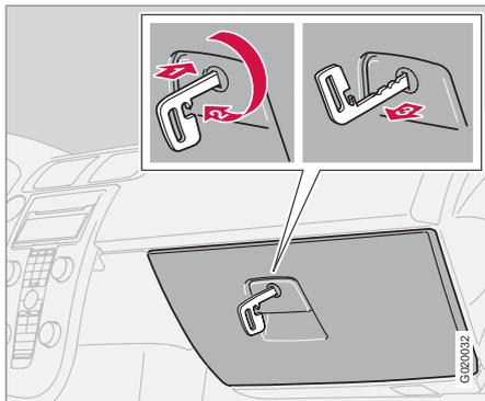
Cette fonction de verrouillage privé a été conçue pour être utilisée lorsque vous devez faire réviser la voiture, à l'hôtel, etc. La boîte à gants est ainsi verrouillée et la serrure du coffre à bagages n'est plus commandée par le verrouillage centralisé. Le coffre à bagages ne peut pas être ouvert que ce soit avec le bouton de verrouillage centralisé de la télécommande ou avec celui des portes avant.
