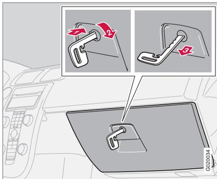
La boîte à gants ne peut être verrouillée/déverrouillée qu'à l'aide de la lame de clé de la télécommande. (Pour de plus amples informations sur la lame de clé, voir page 119.)
