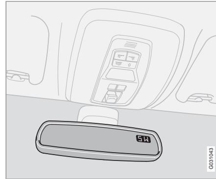
Un écran est intégré dans l'angle supérieur droit du rétroviseur intérieur qui indique la direction de conduite (avant de la voiture). Huit directions différentes sont indiquées avec des abréviations en anglais : **N** (nord), **NE** (nord-est), **E** (est), **SE** (sud-est), **S** (sud), **SW** (sud-ouest), **W** (ouest) et **NW** (nord-ouest).
