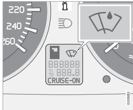
Le capteur de pluie détecte la quantité d'eau sur le pare-brise pour activer automatiquement les essuie-glace. La sensibilité du capteur de pluie peut être réglée avec la molette (C), voir page 62.
