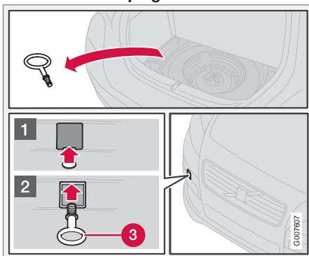
Utilisez l'œillet de remorquage si la voiture doit être remorquée sur route. L'œillet de remorquage se fixe dans l'ouverture de l'enveloppe du pare-chocs avant ou arrière, sur la droite.
