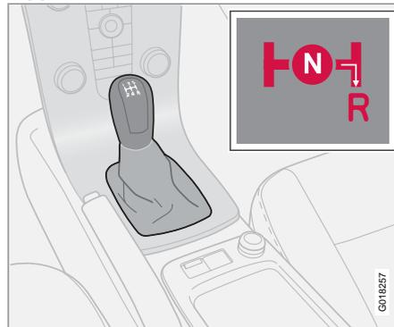
Le verrouillage de marche arrière réduit le risque de passer la marche arrière par erreur lorsque vous roulez normalement en marche avant.
