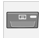
Ce bouton est utilisé pour dégivrer et débarrasser rapidement la lunette arrière et les rétroviseurs extérieurs. Une pression sur le bouton active le chauffage simultané de la lunette arrière et des rétroviseurs.
