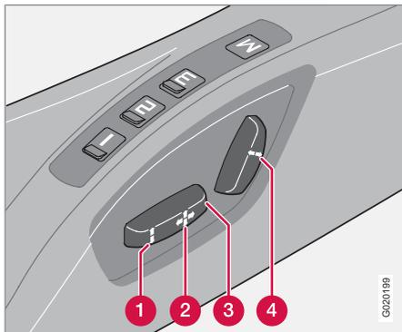
Il est possible de régler le siège un certain temps après avoir déverrouillé la porte avec la télécommande sans insérer la clé dans le contacteur d'allumage. Le siège peut toujours
