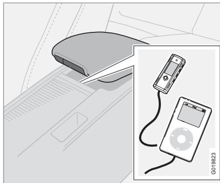
*Il est possible de connecter un iPod ou un lecteur MP3 au système Infotainment de la voiture grâce au port USB de la console centrale.*
