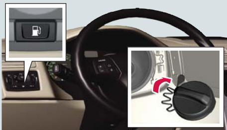
1. Pulse para abrir la tapa del depósito.
