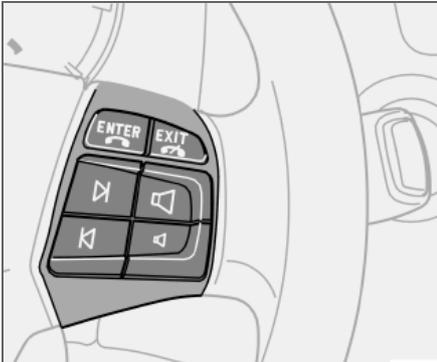
Les quatre touches situées au bas des commandes au volant sont communes à la radio et au téléphone. La fonction du bouton dépend du système activé. Les commandes au volant permettent de régler le volume, de passer d'une station mémorisée à une autre et de changer de plage de CD.
