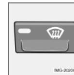
Pour dégivrer et désembuer rapidement le pare-brise avant et les vitres latérales. De l'air est envoyé à grande vitesse de ventilation sur les vitres. Le témoin du bouton de dégivrage s'allume lorsque cette fonction est activée.
