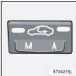
Cette fonction permet d'isoler l'habitacle de l'air vicié extérieur, des gaz d'échappement, etc. L'air de l'habitacle est recirculé. L'air extérieur ne pénètre pas dans la voiture lorsque cette fonction est activée. Si l'air circule trop longtemps dans la voiture, de la buée peut se former sur l'intérieur des vitres.
