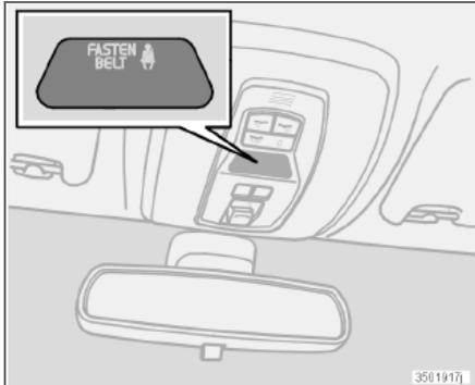
Un rappel lumineux et sonore incite les personnes qui n'ont pas bouclé leur ceinture de sécurité de le faire. Le rappel sonore dépend de la vitesse. Le rappel lumineux est situé dans la console du plafond et dans le combiné d'instruments. À basse vitesse, le rappel sonore retentit pendant les six premières secondes.
