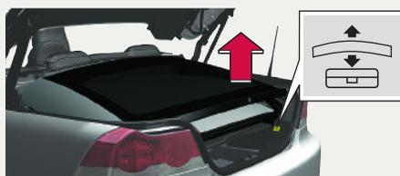
Suba/baje la capota plegada para facilitar la colocación de la carga.
