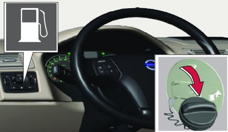
Die Kraftstofftankklappe öffnen. Den Tankverschluss beim Tanken aufhängen.
