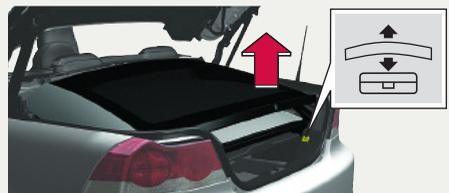
Das heruntergeklappte Verdeck zur Erleichterung der Beladung anheben/absenken.
