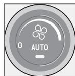
Maintient automatiquement une température d'habitacle choisie en régulant le chauffage, la vitesse du ventilateur, la recirculation et la distribution de l'air.
