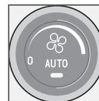
En tournant le bouton, la vitesse du ventilateur augmente ou diminue. La vitesse du ventilateur est régulée automatiquement si **AUTO** est sélectionné. La vitesse de ventilation précédemment
