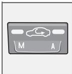
Cette fonction permet d'isoler l'habitacle de l'air vicié extérieur, des gaz d'échappement, etc. L'air de l'habitacle est recirculé. L'air extérieur ne pénètre pas dans la voiture lorsque cette fonction est
