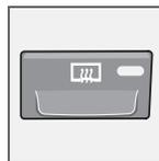
Le chauffage électrique permet de désembuer et de dégivrer la lunette arrière et les rétroviseurs extérieurs. Une pression sur l'interrupteur actionne cette fonction simultanément pour la
