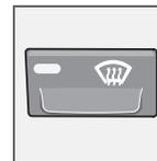
Pour dégivrer et désembuer rapidement le pare-brise avant et les vitres latérales. De l'air est envoyé à grande vitesse de ventilation sur les vitres. Le témoin du bouton de dégivrage s'allume lorsque
