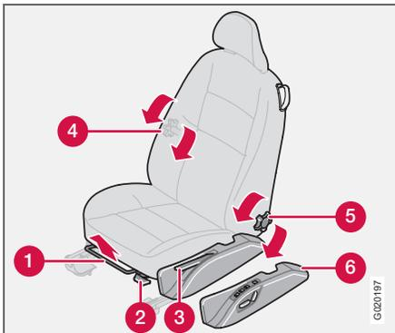
Los asientos del conductor y del acompañante pueden ajustarse para ofrecer una posición de asiento y conducción óptima.
