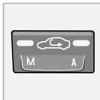
Cette fonction est sélectionnée pour isoler l'habitacle de l'air vicié extérieur, des gaz d'échappements etc. L'air est ainsi recyclé, c'est-à-dire qu'aucun air provenant de l'extérieur de la voiture n'entre dans l'habitacle lorsque la fonction est activée. Lorsque vous actionnez la recirculation d'air trop longtemps, du givre ou de la buée peuvent se former à l'intérieur des vitres.
