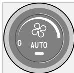
Tournez la molette pour augmenter ou réduire la vitesse du ventilateur. Si **AUTO** est sélectionné, la vitesse du ventilateur est réglée automatiquement. Le précédent réglage de la vitesse de ventilateur est supprimé.
