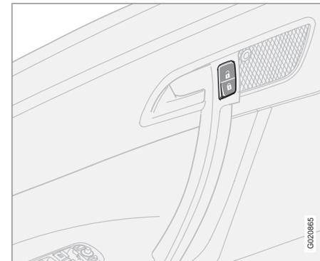
Le bouton de verrouillage situé près de la poignée d'ouverture de portière permet de verrouiller et de déverrouiller simultanément les portières et le coffre à bagages.
