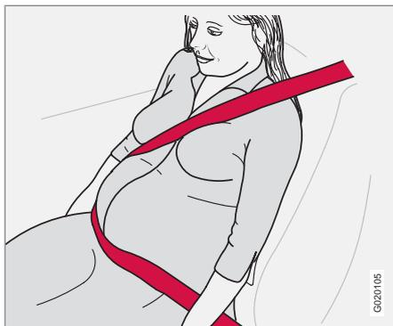
La ceinture de sécurité doit toujours être utilisée pendant la grossesse. Mais il est important de l'utiliser correctement. La ceinture de sécurité doit se coller contre l'épaule et la partie diagonale doit se placer entre les seins et sur le côté du ventre. La sangle basse de la ceinture de sécurité doit reposer bien à plat sur le côté des cuisses et le plus sous le ventre possible. Elle ne doit pas glisser et remonter sur le ventre. Elle ne doit pas être lâche mais suivre
