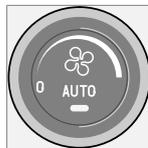
La fonction **AUTO** permet de réguler automatiquement la climatisation afin d'atteindre la température souhaitée. Cette fonction contrôle le chauffage, la climatisation, la ventilation, la recirculation et la distribution de l'air.
