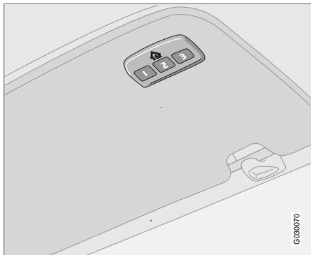
HomeLink es un mando a distancia programable que puede controlar hasta tres dispositivos diferentes (por ejemplo, puerta del garaje, sistema de alarma, iluminación exterior e interior, etc.) y utilizarse por tanto en lugar de los mandos a distancia de estos. El HomeLink se suministra integrado en la visera izquierda.
