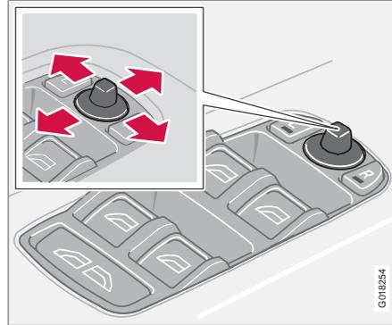
Los mandos para ajustar los dos retrovisores exteriores están situados en el extremo delantero del apoyabrazos del conductor. Los retrovisores pueden accionarse con el encendido en la posición I y II.
