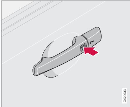
Los automóviles con el sistema "Keyless" tienen un botón en el tirador exterior de las puertas.
