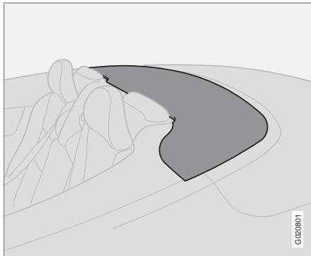
Cuando la capota está abierta, hay una tapa de protección entre los reposacabezas del asiento trasero y el maletero, ve la figura anterior.
