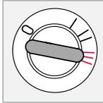
Se conecta el motor de arranque. En cuanto arranca el motor, la llave se suelta y vuelve de forma automática a la posición de conducción.
