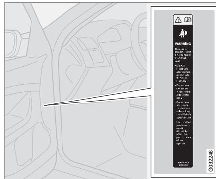
La pegatina del airbag lateral está situada en la parte delantera, en el lado del conductor en los automóviles preparados para conducir por la izquierda.
