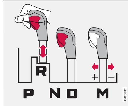
La palanca puede desplazarse libremente hacia adelante o hacia atrás entre **N** y **D**. Las demás posiciones tienen un seguro que se controla con el botón de bloqueo del selector de marchas.
