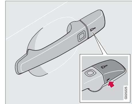
Si no es posible activar el cierre centralizado con el mando a distancia, por ejemplo, si las pilas están gastadas, la puerta del conductor puede abrirse de la siguiente manera:
