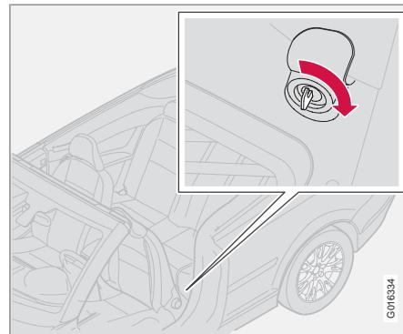
Si el sistema eléctrico del automóvil deja de funcionar temporalmente, el maletero puede abrirse mecánicamente con la llave extraíble del mando a distancia. Para obtener información sobre la extracción de la llave, ver la página 119.
