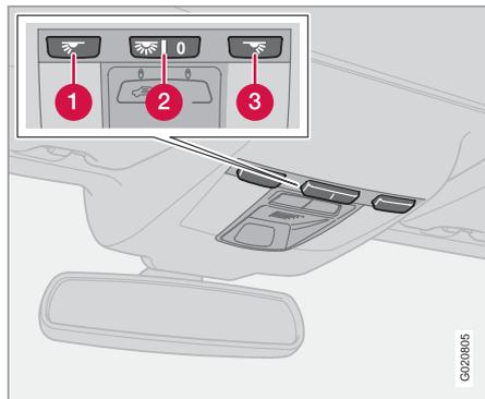
Mando en la consola del techo de las luces de lectura delanteras y la iluminación del habitáculo.
