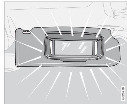
La luz se enciende o apaga automáticamente cuando la tapa se abre o cierra.
