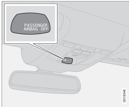
Indicación que muestra que el airbag (SRS) del acompañante está desconectado.
