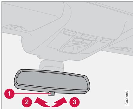
Si hay una luz muy intensa detrás del automóvil, esta luz puede ser reflejada por el espejo retrovisor y deslumbrar al conductor. Accione el mando cuando resulte molesta la luz que hay detrás del automóvil.
