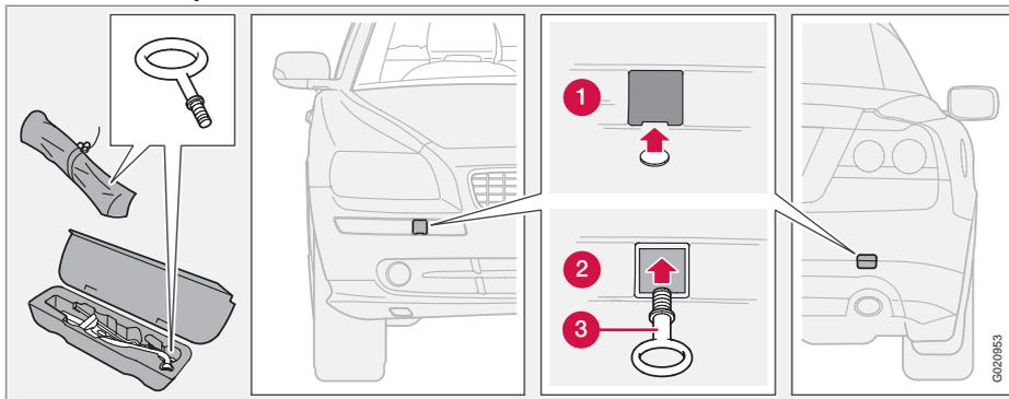
Utilice la anilla de remolque si es necesario remolcar el automóvil por la vía pública. La anilla de remolque se fija en la ranura situada en el lado derecho del parachoques delantero o trasero.
