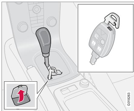
Algunas veces es necesario desplazar el automóvil sin que éste sea maniobrable, por ejemplo, si está descargada la batería. Proceda de la siguiente manera para desplazar el automóvil:
