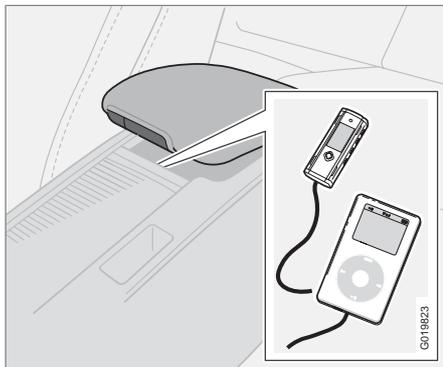
Mediante el enchufe USB de la consola central puede conectarse un iPod o un reproductor de mp3 al sistema de infotainment del automóvil.
