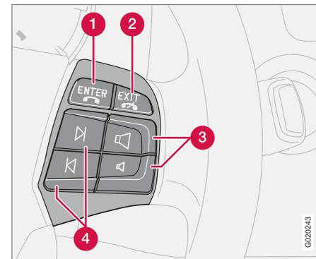
Cuando el teléfono está activado, el teclado del volante sólo controla las funciones de telefonía. Para controlar el equipo de sonido, el teléfono debe estar en modo de espera (standby).
