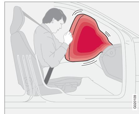
Como complemento del cinturón de seguridad, el automóvil está equipado con un airbag <sup>1</sup> que está plegado en un compartimento encima de la guantera en el lado del acompañante. El panel lleva estampadas las letras **SRS AIRBAG**.
