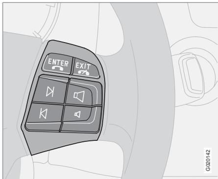
Las cuatro teclas inferiores del teclado del volante se utilizan tanto para la radio como para el teléfono. La función del botón depende del sistema que está activo. Con el teclado del volante puede alternar entre emisoras preseleccionadas, cambiar de pista de CD/MD y ajustar el volumen.
