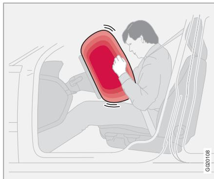
Como complemento del cinturón de seguridad del lado del conductor, el automóvil está equipado con un airbag SRS (Supplemental Restraint System). El airbag está plegado en el centro del volante. El volante lleva estampadas las letras **SRS AIRBAG**.
