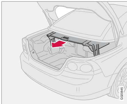
El propósito de la bandeja de separación es reducir el volumen de la carga del maletero para no obstaculizar el movimiento de la capota. Cierre debidamente la bandeja de separación de manera que quede fijada en el lado izquierdo y derecho.
