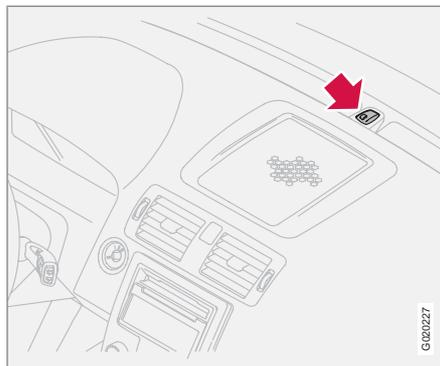
El tablero de instrumentos tiene un diodo luminoso rojo que indica el estatus del sistema de alarma:
