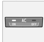
**ON:** El aire acondicionado está conectado. El sistema se regula automáticamente. De esta manera, el aire que entra se enfría y deshumedece.
